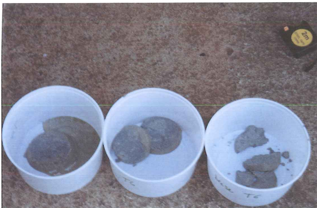
FIGURA 5.3. Fatias retiradas de cada nível para análises químicas(FRX), metais biodisponíveis e de toxicidade pós-experimento
