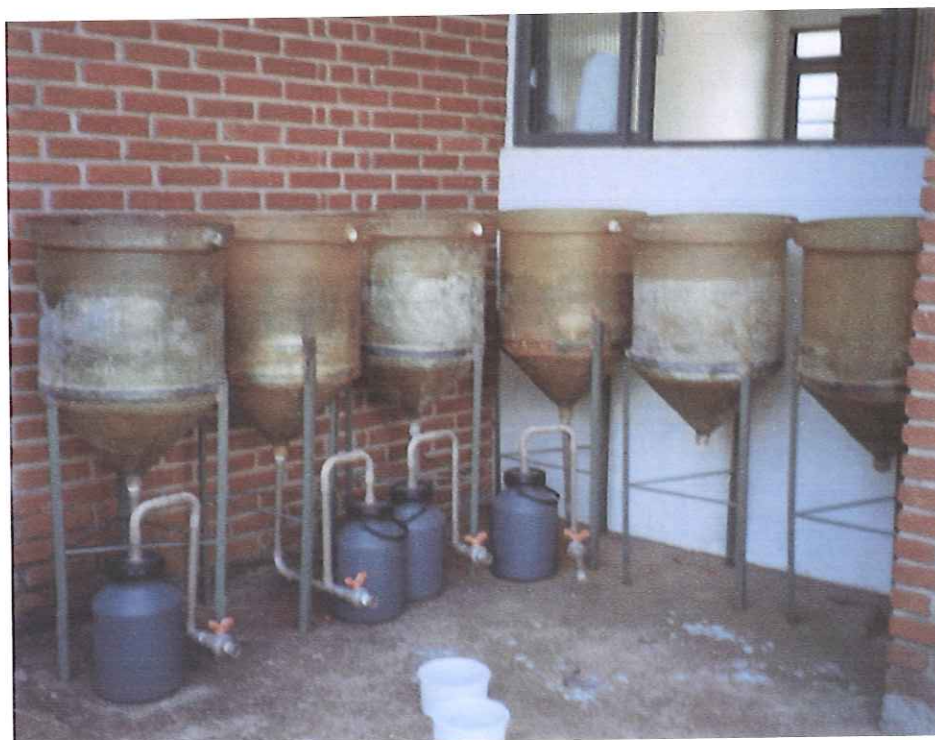
FIGURA 5.1. Tanques experimentais: 1 a 4 de lixiviação com recipientes para coleta dos lixiviados e 5 e 6 com cobertura úmida
