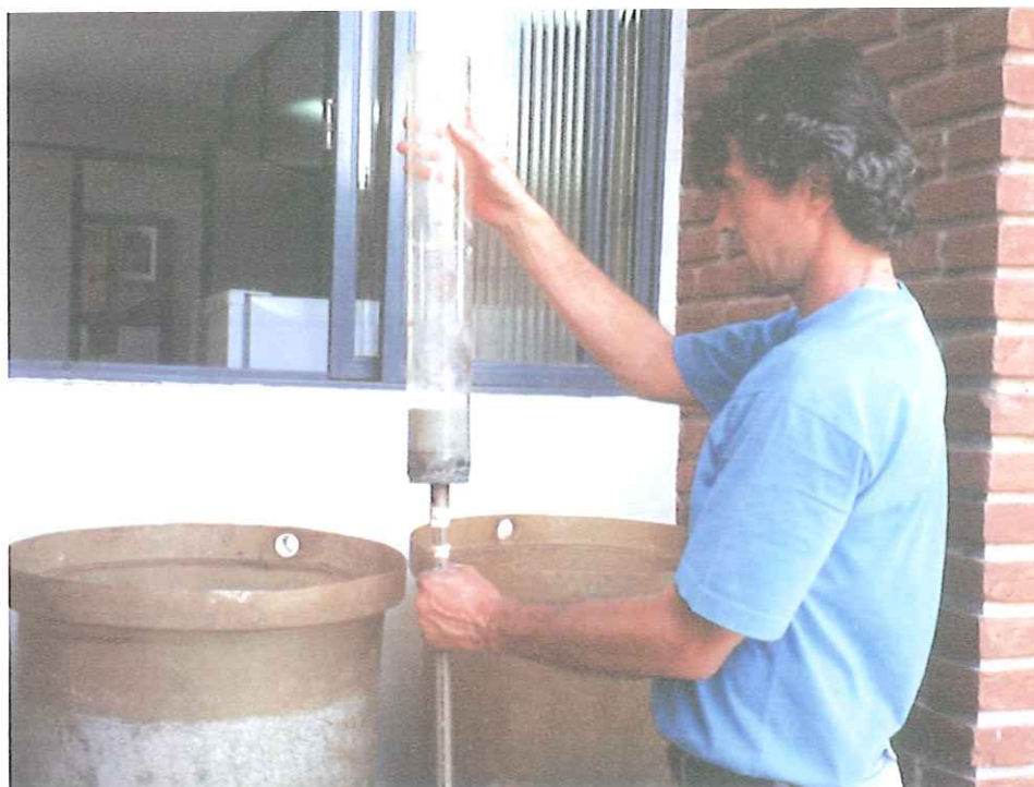
FIGURA 5.2. Retirada de amostras dos tanques pós-experimento utilizando-se amostrador de sedimentos do tipo corer
