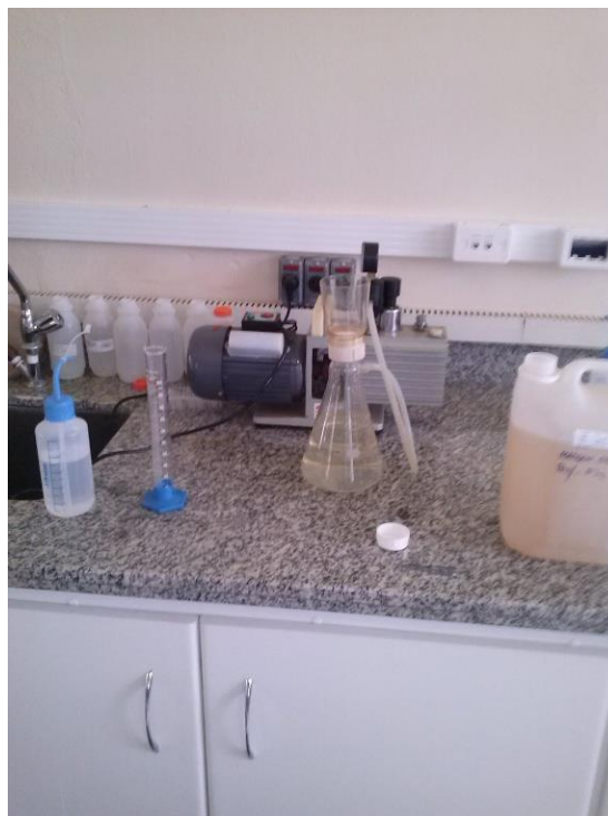
Figura 30 - Método de Filtração destacando a amostra e bomba à vácuo Fonte: Autor
