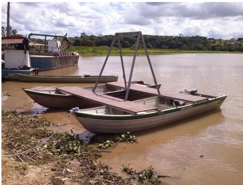
Figura 17 - Plataforma catamarã construída para dar mais segurança às atividades de campo sobre a água
