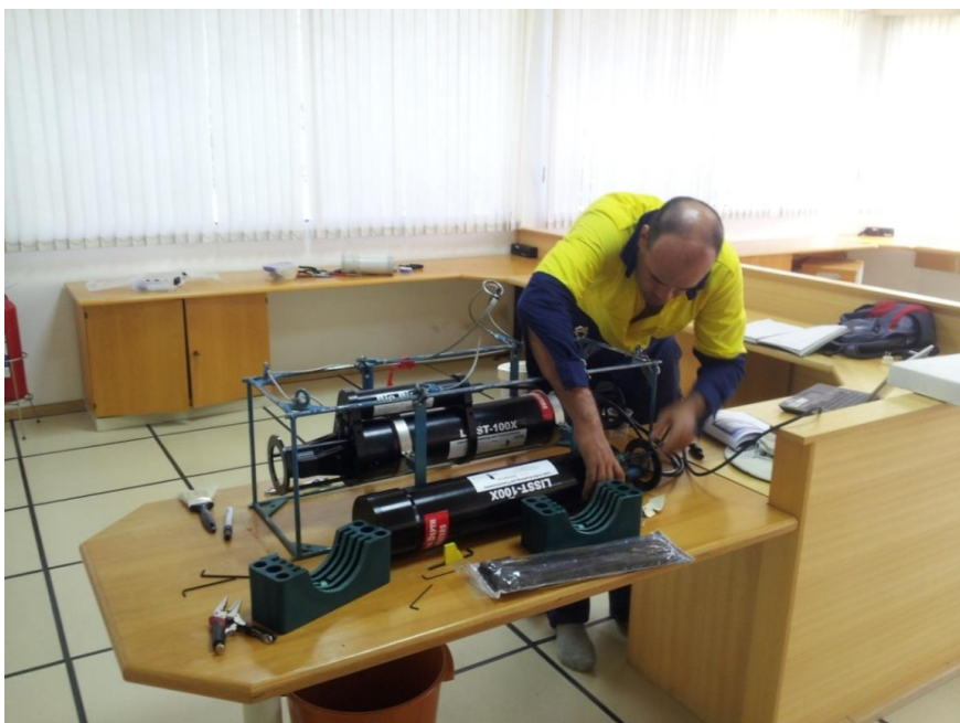
Figura 18 - Preparação e montagem da LISST e da bateria na gaiola de proteção Fonte: FIPAI (2015)
