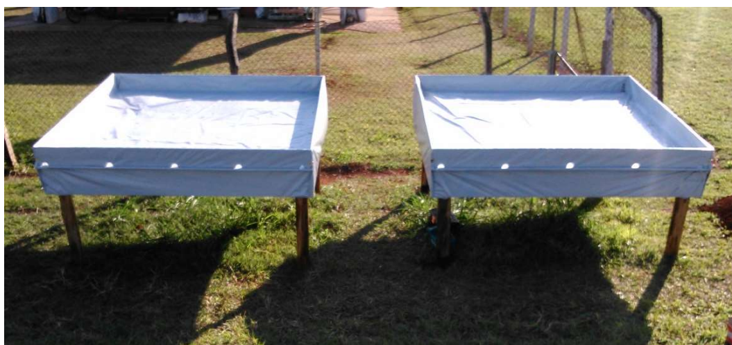
Figura 12: Aplicação da membrana de PEAD. Fonte: Arquivo do autor.
