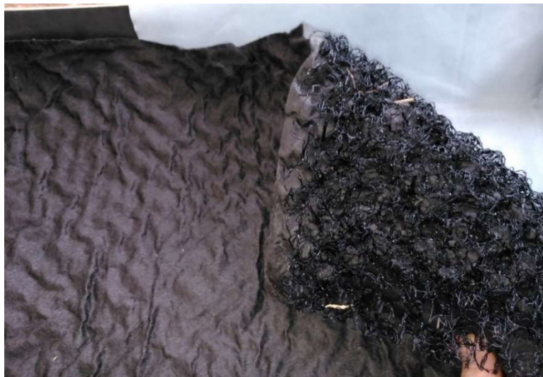
Figura 13: Geocomposto estruturado. Fonte: Arquivo do autor.
