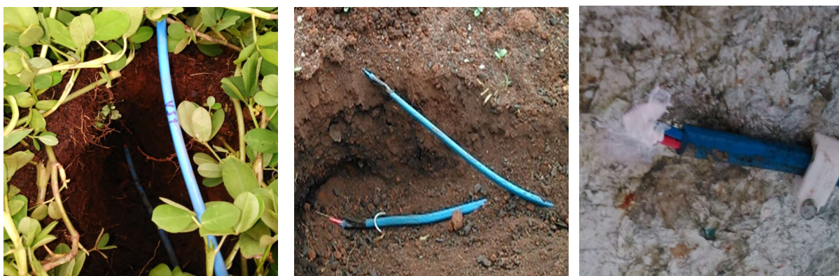
Figura 20: Posicionamento dos sensores superiores: (A) na cobertura verde, (B) na cobertura controle e (C) inferiores das plataformas. Fonte: Arquivo do autor.
