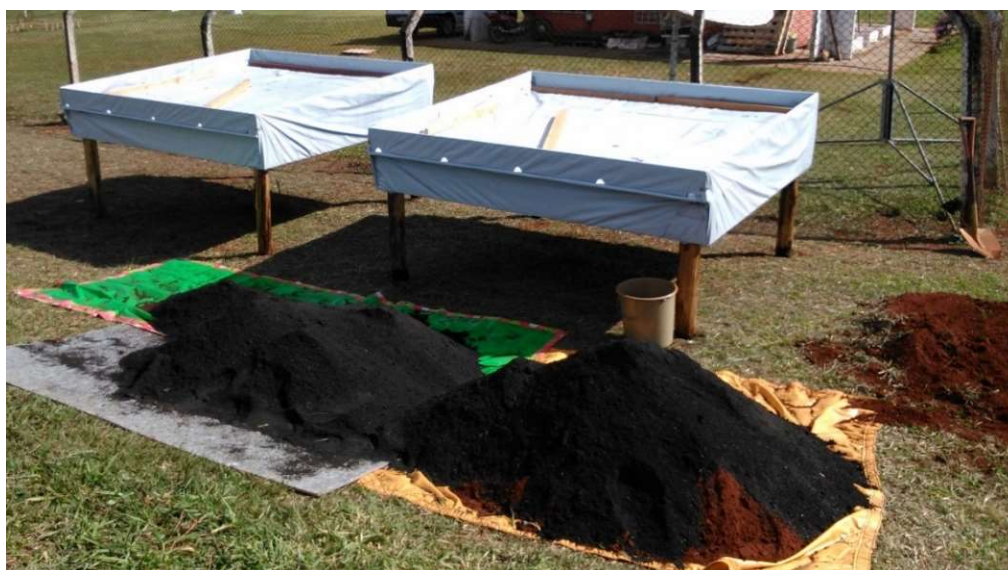
Figura 14: Elaboração do substrato para o preenchimento das plataformas. Fonte: Arquivo do autor.
