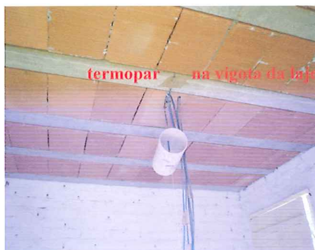
Figura 28 – colocação do termopar na vigota de concreto da laje. Para a sua colocação onde foi feito um pequeno orifício na vigota de concreto da laje, onde foi colocada uma pasta térmica para melhorar a condutividade térmica da ponta do termopar, que posteriormente foi colocada dentro do pequeno orifício feito na vigota. Para ajudar na fixação do termopar na laje, foi utilizada fita adesiva, como pode ser observado na figura acima.
