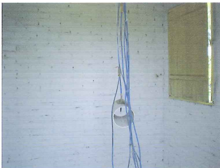
Figura 29 – colocação do termopar a 1,10m do piso. Observa-se que a ponta do termopar está dentro de um “shield” para evitar a influência da radiação na medida da temperatura interna do ar – tbs.
