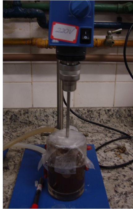
Figura 5.4 - Equipamentos utilizados na hidrólise do BC explodido com enzimas produzidas no biorreator de colunas instrumentado.
