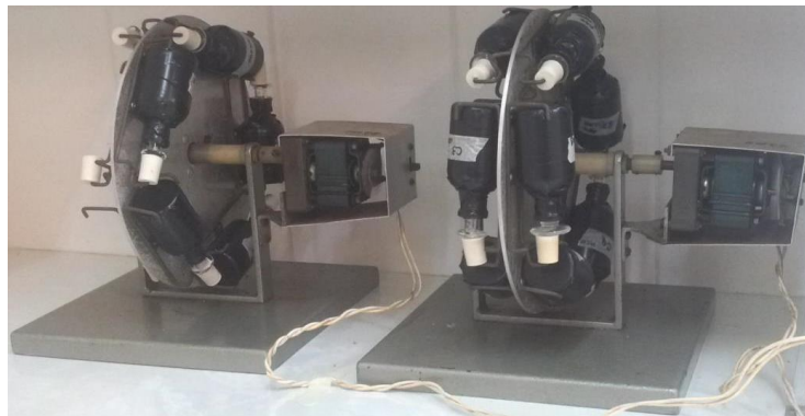
Figura 17. Experimento de taxa de alimentação de C. silvestrii em câmara giratória
