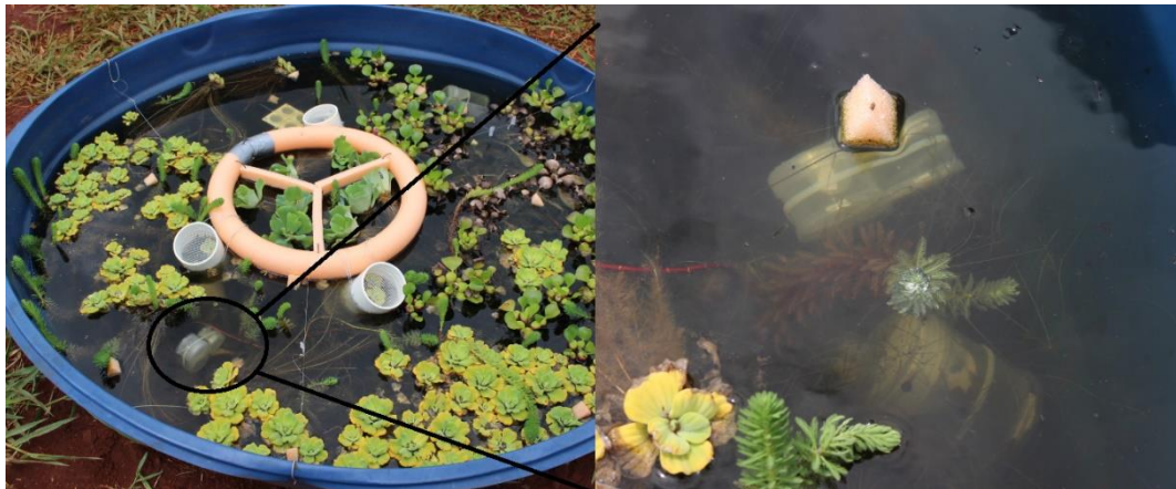
Figura 16. Armadilhas inseridas nos mesocosmos para os testes de toxicidade aguda com C. silvestrii
