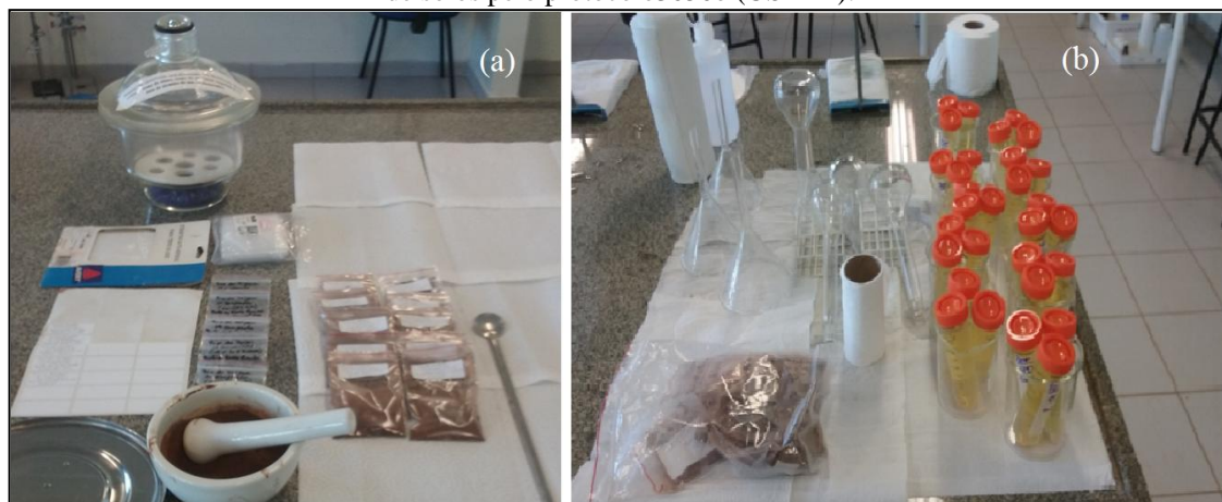
Figura 16 - Emprego de técnicas limpas em: (a) preparação de sedimentos para análise térmica; (b) preparação de solos pelo protocolo 3050b (USEPA).
