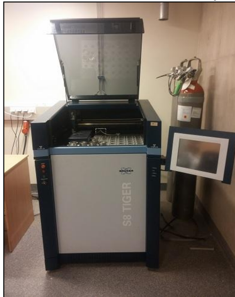
Figura 25 - Aparelho WDXRF utilizado na análise de óxidos minerais majoritários nas amostras de sedimentos.
