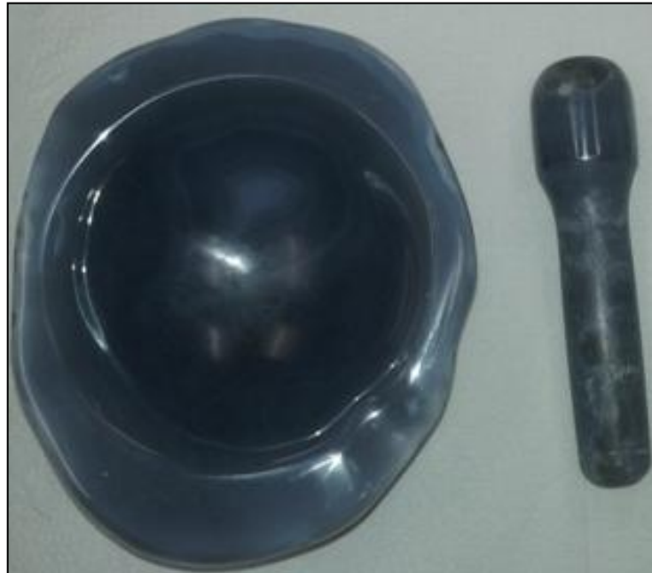
Figura 22 - Grau e pistilo de ágata utilizados para desagregar manualmente amostras que foram secas em estufa.
