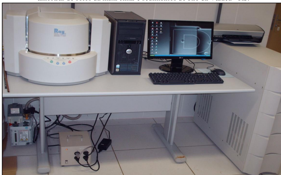
Figura 26 - Aparelho EDXRF utilizado na análise de óxidos minerais majoritários e elementos traço nas amostras de solos da mata ciliar e sedimentos do Rio da Várzea - RS.
