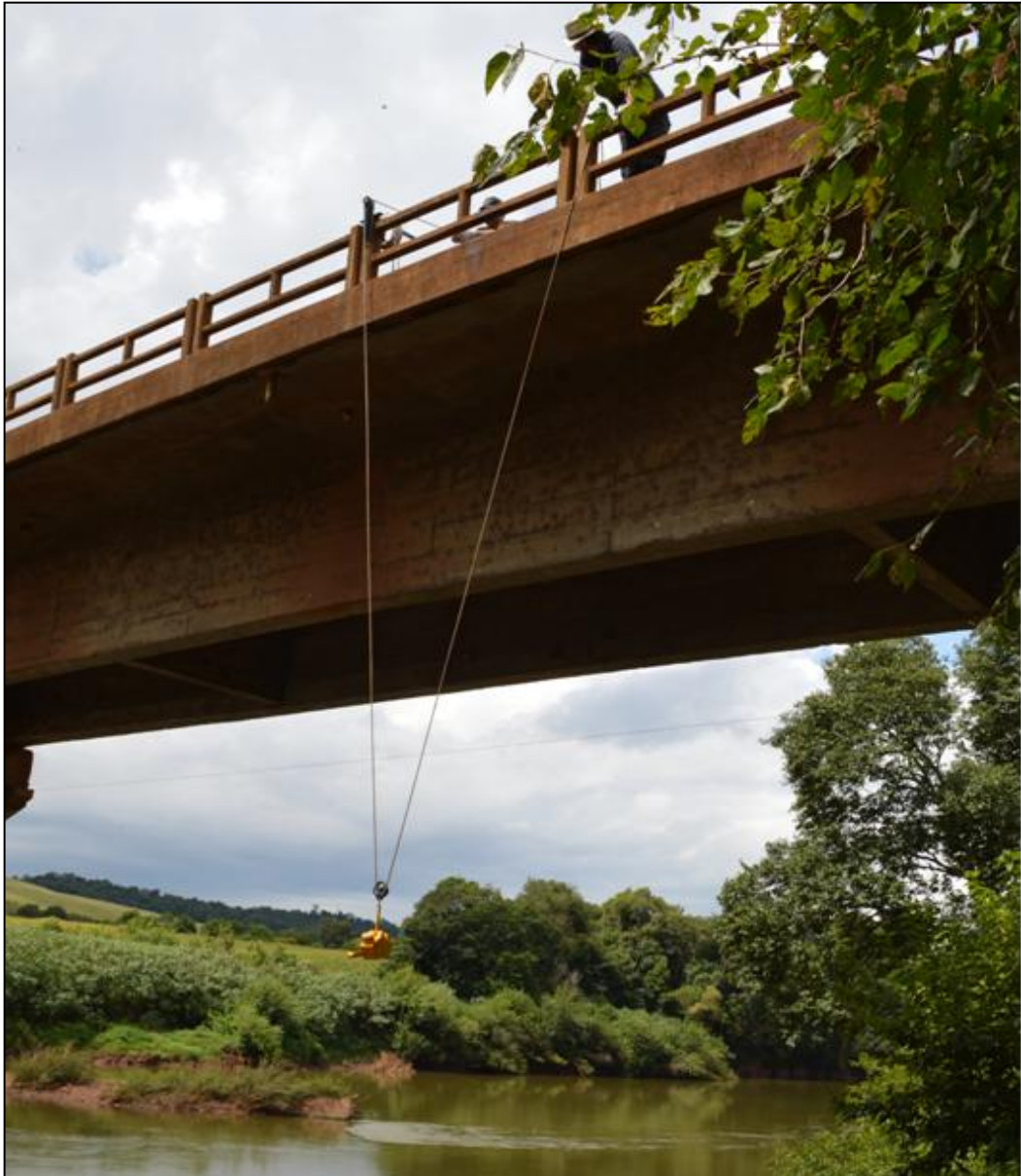
Figura 18 - Amostragem de sedimentos com draga Petersen com polia móvel (3ª Campanha, Rodeio Bonito).
