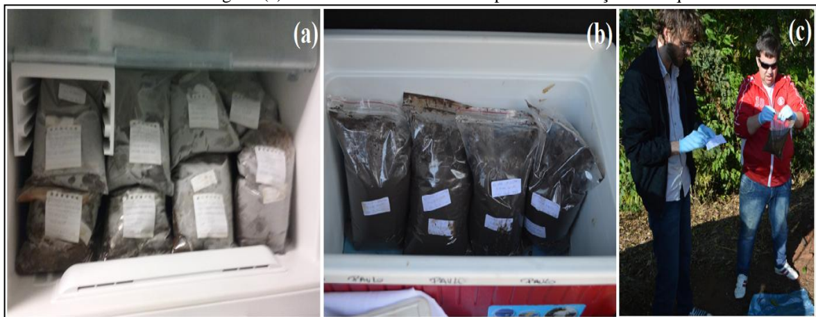
Figura 21 - Detalhes das coletas: (a) Amostras preservadas em um freezer; (b) Amostras conservadas em caixa térmica com criogel e (c) armazenamento em sacos ziplock e colocação de etiquetas.
