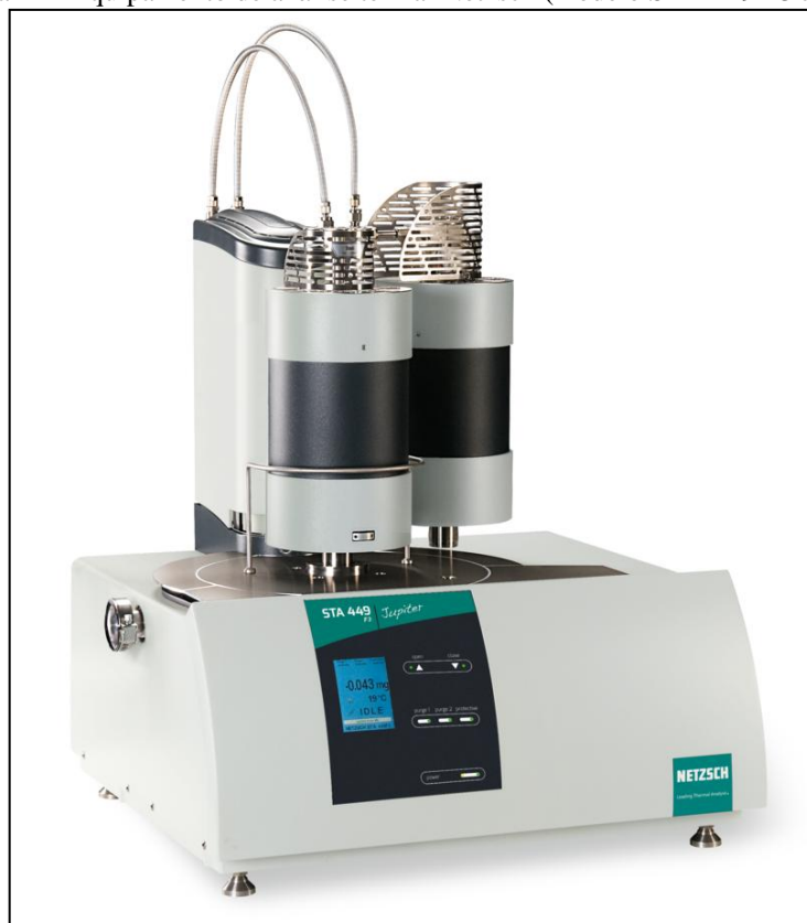
Figura 24 - Equipamento de análise termal Netzsch (modelo STA 449 F3 Jupiter).
