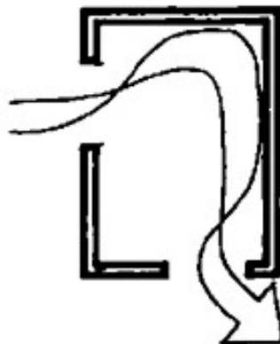
Figura 29. Esquema de ventilación cruzada en planta
