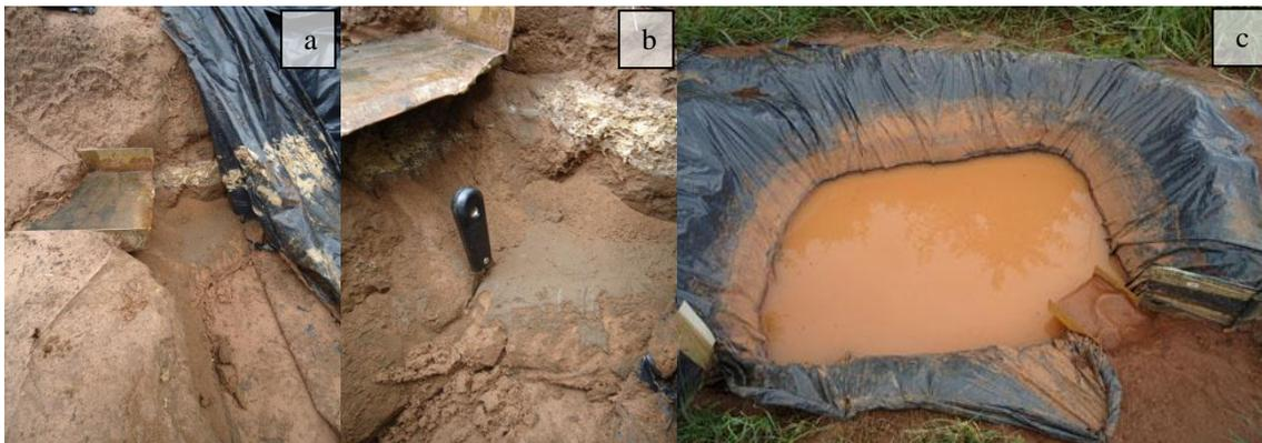
Figura 51 – Intercorrências durante o estudo observacional: “a” e “b” – infiltração dos sedimentos antes da bica de metal; c – Encerado plástico rasgado
