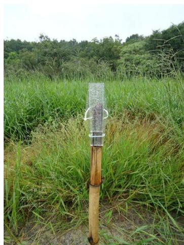
Figura 47 – Pluviômetro instalado em campo
