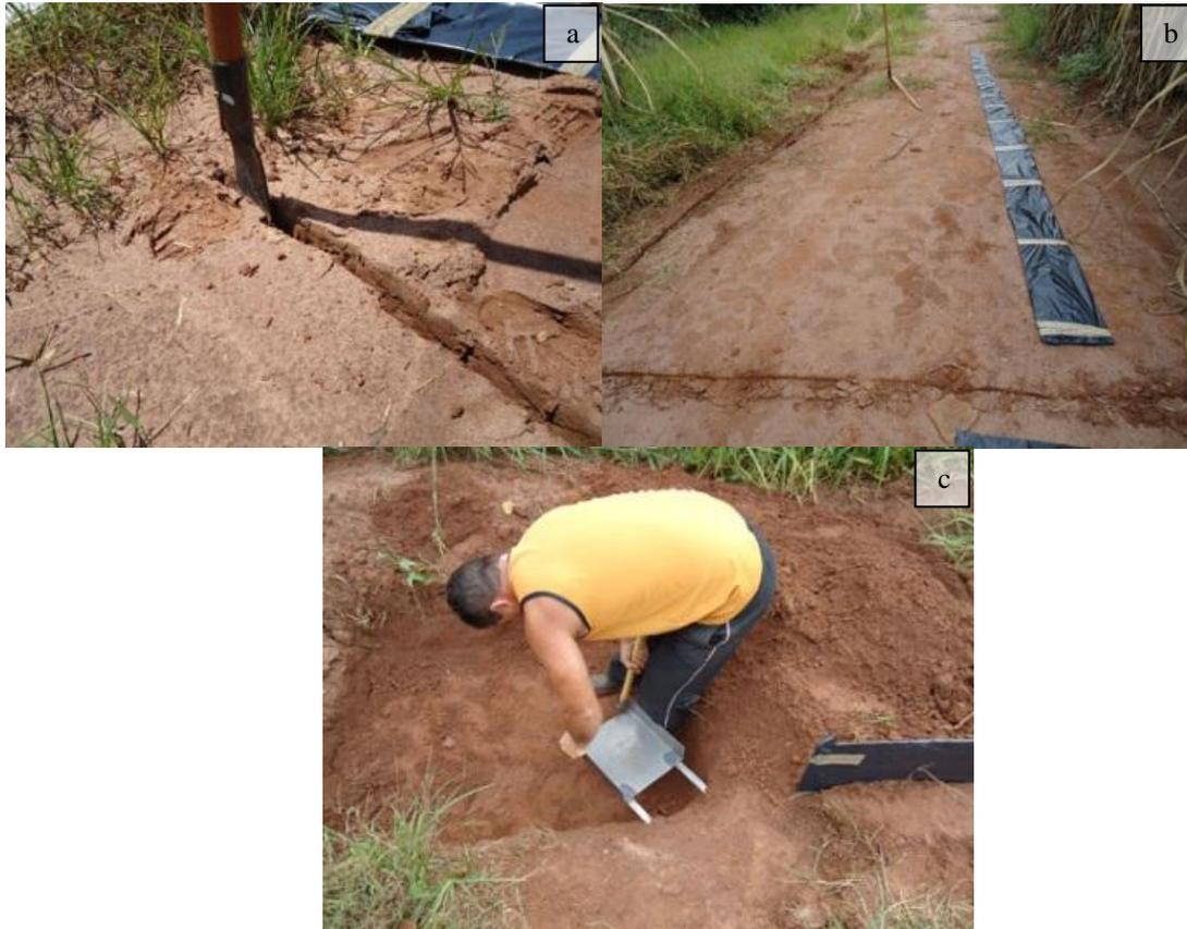
Figura 22 – Montagem das parcelas, com destaque para a abertura das fendas (a), junção das placas (b) e colocação da bica de metal
