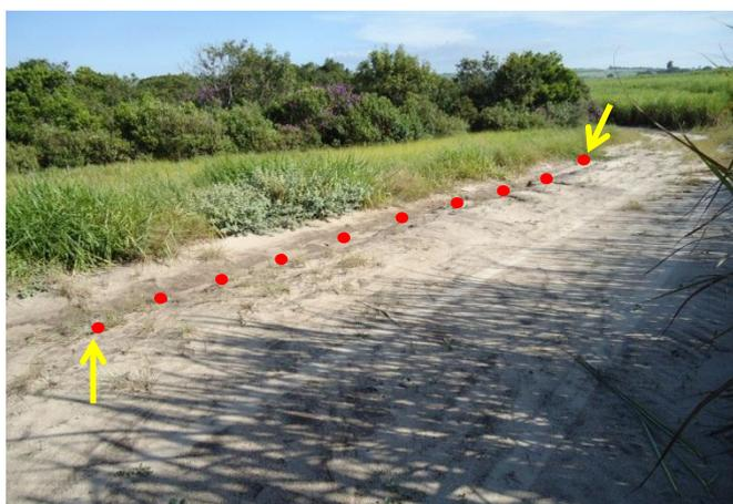
Figura 43 – Representação da instalação de pinos erosivos em trecho de carregador
