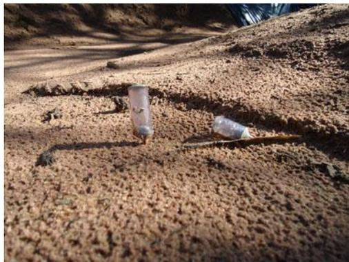
Figura 45 – Cápsula para captação de filete d'água durante evento chuvoso
