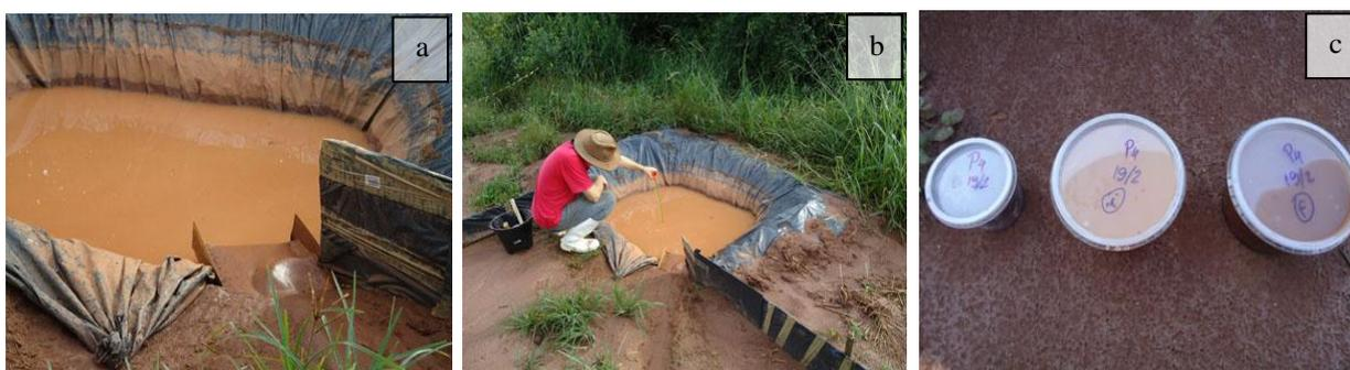
Figura 25 – (a) Procedimento de coleta, com exame visual, (b) medições e (c) acondicionamento das amostras coletadas
