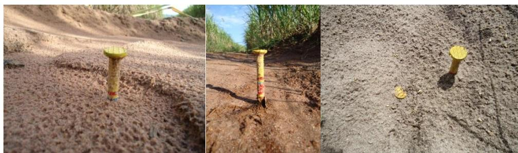
Figura 44 – Pinos erosivos instalados em campo
