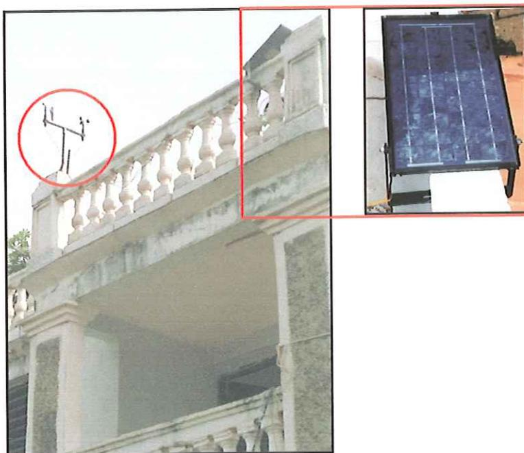
Figura 9: Fachada principal da casa 6 Bloco 1 (sistema construtivo: abóbada de argamassa armada - México). Local onde se encontra instalada a estação automática climatológica CR10, sendo possível identificar, em detalhe na cor vermelha, sensores de direção (anemoscópio) e velocidade do vento (anemômetro), a altura aproximada de 6 metros. Ao lado esquerdo, percebe-se o painel solar (na foto menor detalhe do painel para produção de energia). Foto: Adeildo Cabral da Silva, 2001.
