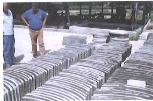
Figura 22: Detalhes do módulo de cobertura e entrepiso lam – Cuba
