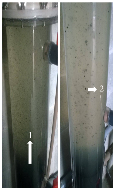
Figura 4.4 - Reator EGSB Logo Após a Inoculação: (1) Lodo e (2) Grânulos do lodo Adensando.
