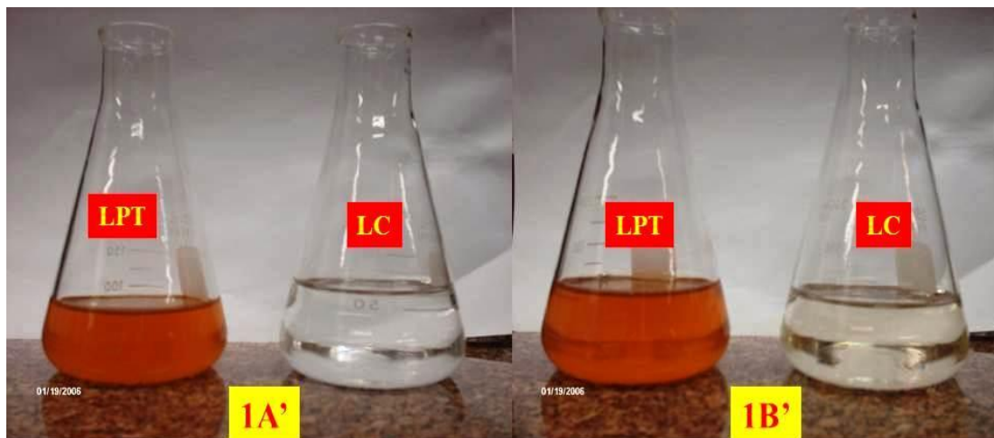
Fotografia 21– Tratamento 1 aplicado ao lixiviado pré-tratado por “ air-stripping ”. (LPT) lixiviado pré-tratado por “ air-stripping ” acidificado; (LC) lixiviado coluna.
