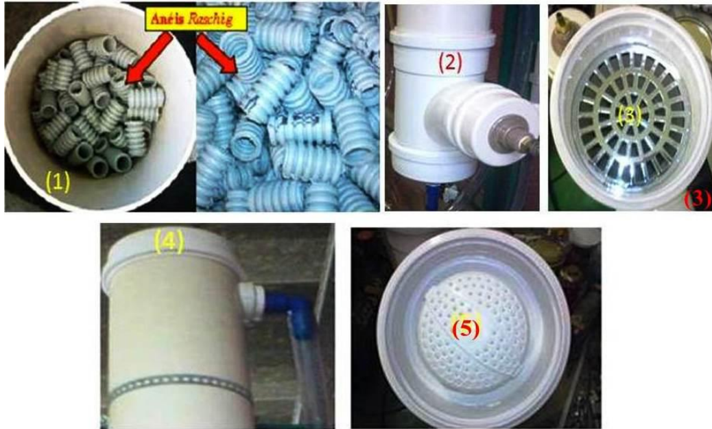
Fotografia 6 – detalhes da torre de “air-stripping”. (1) parte interna da torre com os anéis de “Raschig”; (2) parte inferior da torre; (3) fundo falso da torre; (4) topo da torre com saída lateral do gás efluente; (5) distribuidor de lixiviado.
