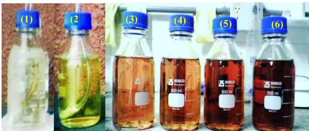
Fotografia 15– Frascos lavadores com KI 2% m/v; (1) KI 2% m/v sem contato com O_3 ; (2), (3), (4), (5) e (6) KI 2% m/v em ordem crescente de saturação após contato com O_3 .
