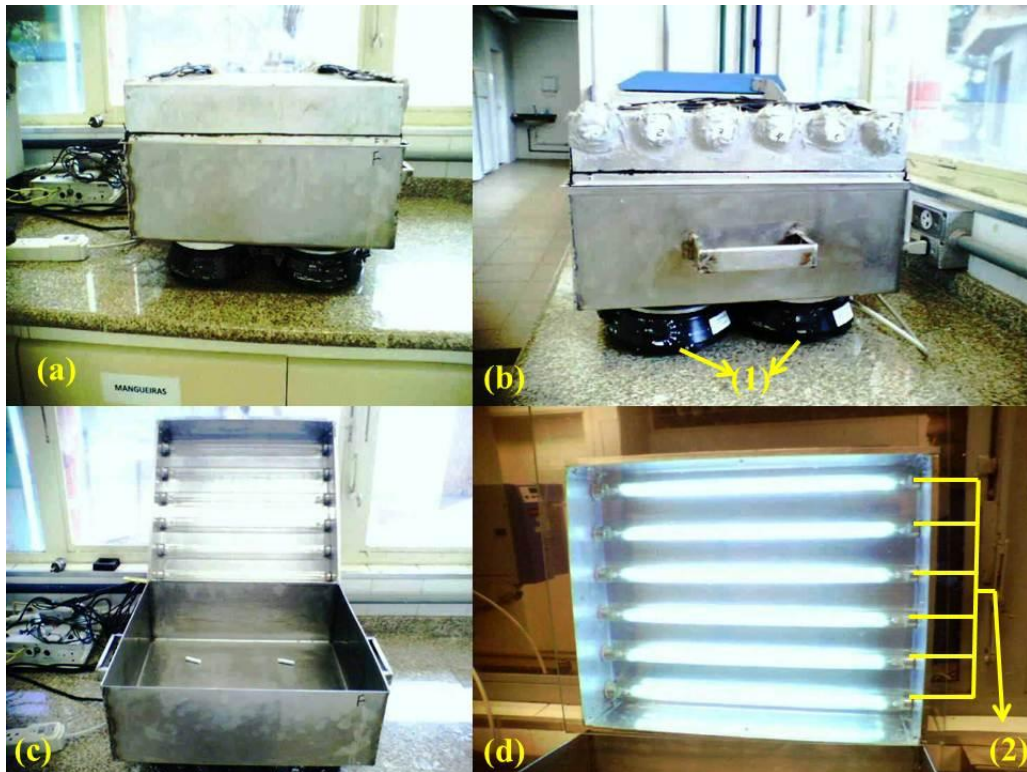
Fotografia 16– (a) visão frontal do reator UV; (b) visão lateral do reator UV; (c) visão frontal do reator UV aberto; (d) visão do refletor com lâmpadas UV acesas; (1) agitadores magnéticos; (2) lâmpadas UV.
