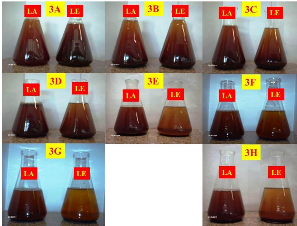
Fotografia 24– Tratamento 3 aplicado ao lixiviado bruto. (LA) lixiviado afluente ao tratamento 3; (LE) lixiviado efluente ao tratamento 3.
