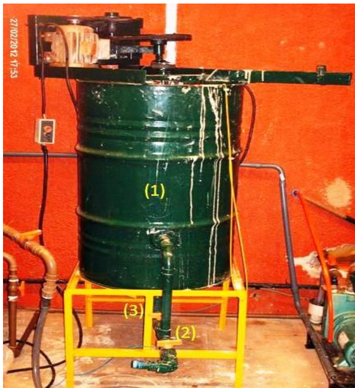
Fotografia 4 – Agitador mecânico. (1) Tambor de 100 L; (2) registro de saída do sobrenadante; (3) registro de saída do lodo.
