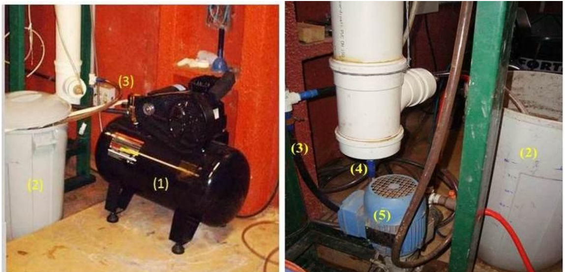
Fotografia 7– (1) Compressor de ar; (2) recipiente plástico de 100 L com o lixiviado; (3) mangueira de retorno do lixiviado da torre para o recipiente; (4) saída de lixiviado da torre; (5) bomba injetora de lixiviado.
