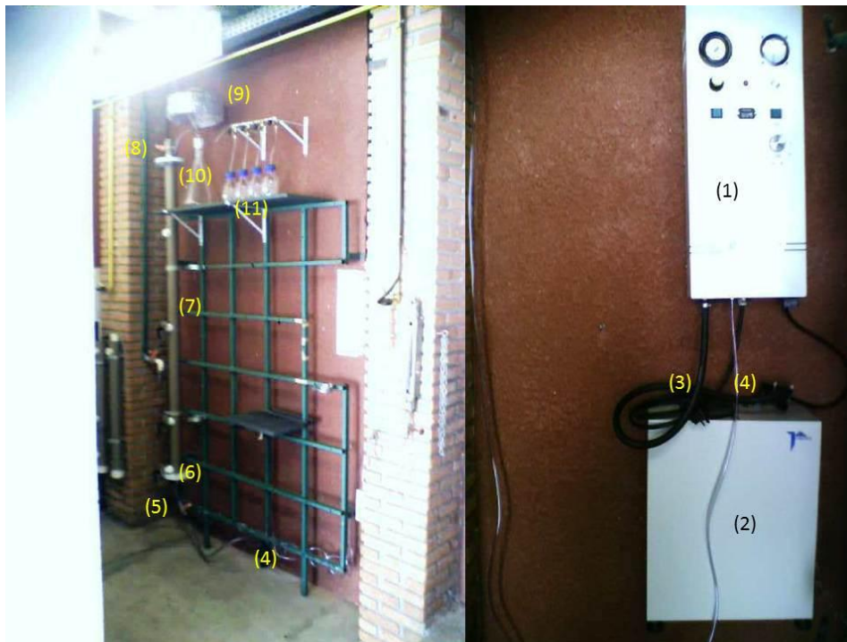
Fotografia 9– Unidade utilizada para os ensaios com ozônio. (1) ozonizador; (2) gerador de O_2 ; (3) mangueira injetora de O_2 ; (4) mangueira injetora de O_3 ; (5) coletor de amostras; (6) inserção com seringa do H_2O_2 ; (7) coluna de ozonização; (8) inserção de lixiviado; (9) mangueira espiralada; (10) Erlenmeyer coletor de espuma; (11) frascos lavadores de gás com KI 2% m/v.
