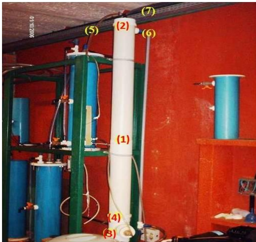
Fotografia 5– (1) Torre recheada aerada utilizada no pré-tratamento por “ air-stripping ”. (1) torre recheada aerada; (2) parte superior da torre; (3) parte inferior da torre; (4) mangueira injetora de ar; (5) mangueira injetora de lixiviado; (6) saída lateral do gás efluente; (7) mangueira ejetora do gás efluente.
