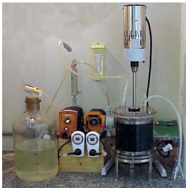
FIGURA 4.2 – Montagem experimental do ASBR com microrganismos imobilizados em cubos de espuma de poliuretano e tratando água residuária sintética.
