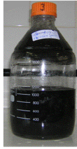
Figura 13. Frasco reator utilizado no enriquecimento da amostra de sedimento
