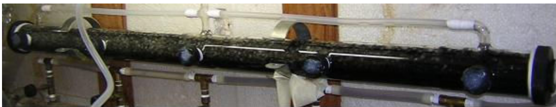
Figura 26. Reatores anaeróbio horizontal de leito fixo (RAHLF) inoculado, por bombeamento em circuito fechado, durante 72 horas, do sedimento enriquecido em meio mineral Biota.
