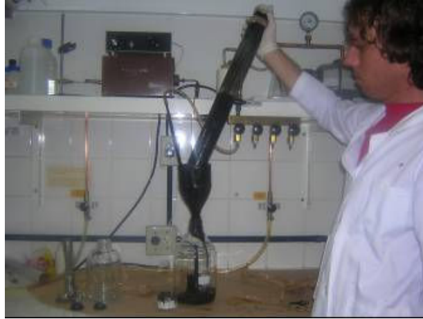
Figura 10. Procedimento de transferência do sedimento dos “cores” para os frascos Duran sob condições de anaerobiose.
