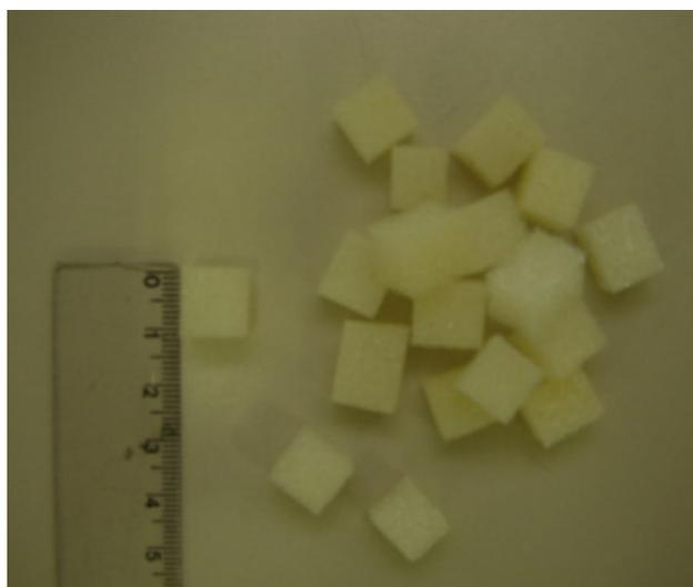
Figura 4.4 – Fotografia dos cubos de espuma de poliuretano
