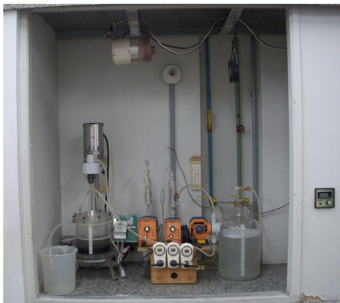
Figura 4.6 – Fotografia do aparato experimental do AnSBR
