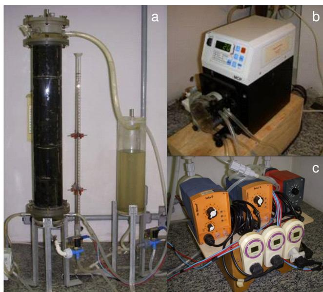
Figura 4.3 – Fotografias: (a) do reator (esquerda), do reservatório (direita) e do tubo graduado (centro), (b) da bomba peristáltica e (c) das bombas de diafragma e dos temporizadores
