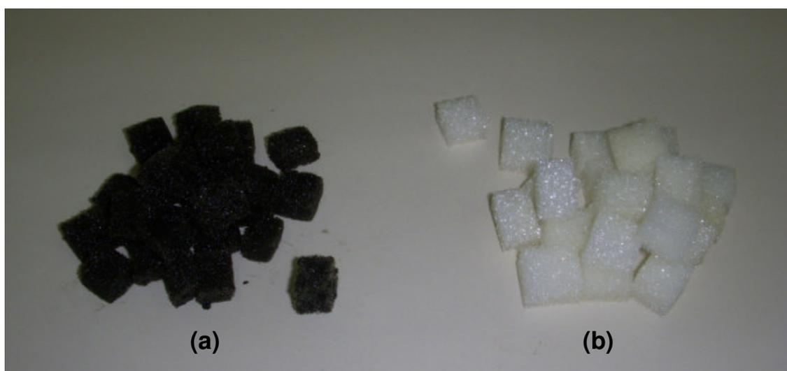
Figura 4.9 – Espuma de poliuretano (b) antes e (a) depois da imobilização
