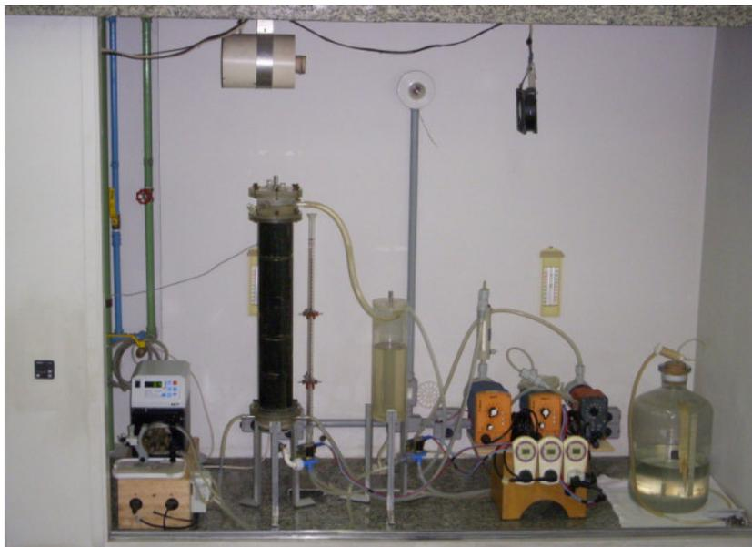
Figura 4.2 – Fotografia do aparato experimental do AnSBBR
