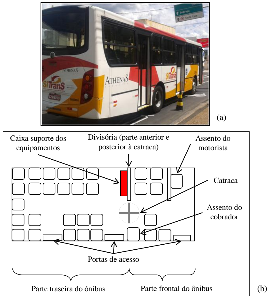
Figura 2 – (a) Ônibus da Linha 04; (b) planta baixa simplificada do seu interior.
