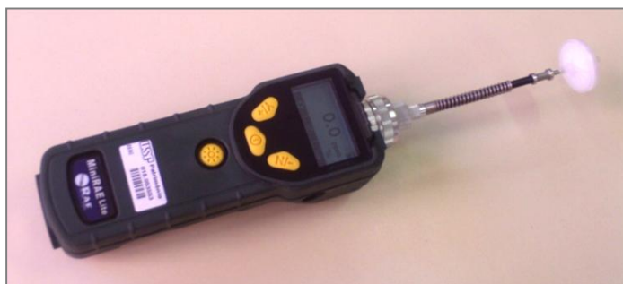
Figura 9 – Monitor de Compostos orgânicos voláteis totais MiniRAE Lite , marca RAE Systems.
