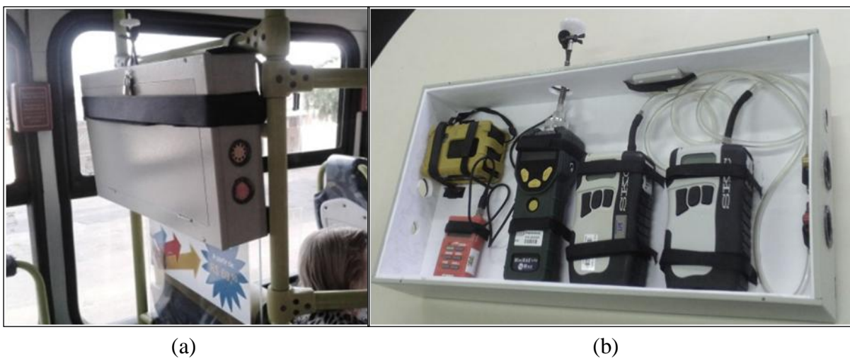
Figura 3 – (a) Caixa suporte dos equipamentos dentro do ônibus; (b) visão interna da caixa suporte.
