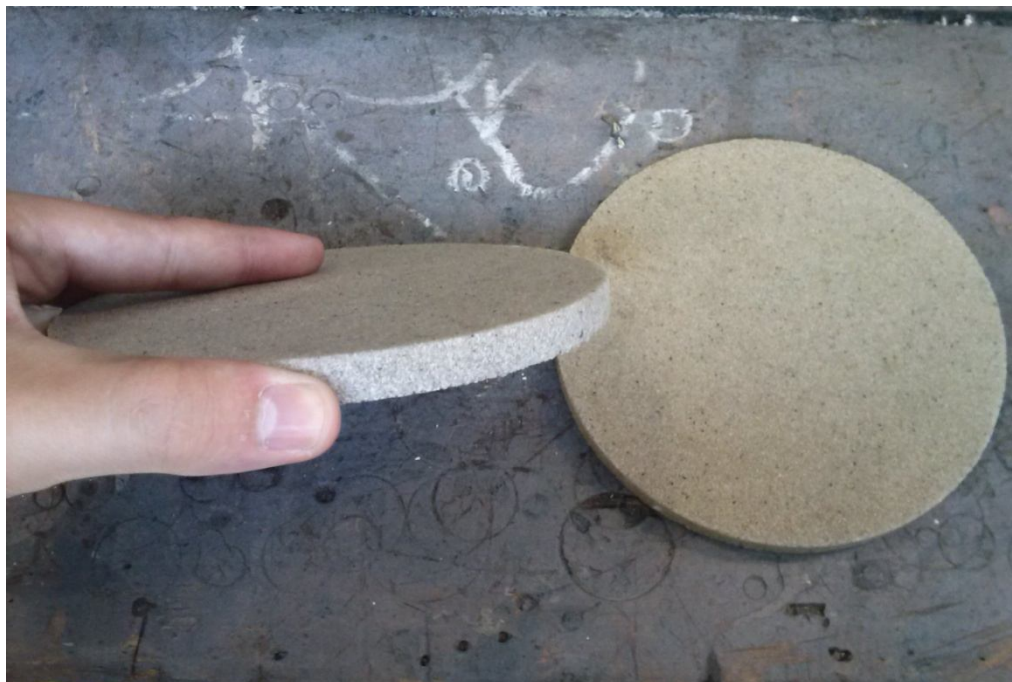
Figura 4.4: Placas de vidro siterizado usadas para difusão do ar
