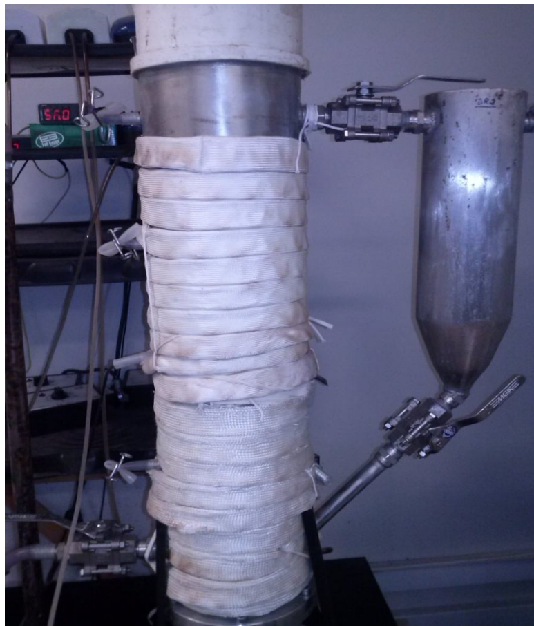
Figura 5.34: Sistemas de controle da temperatura de operação
