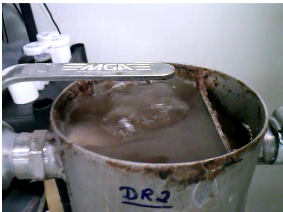
Figura 5.6: Bolha de ar ascendente formada no decantador secundário
