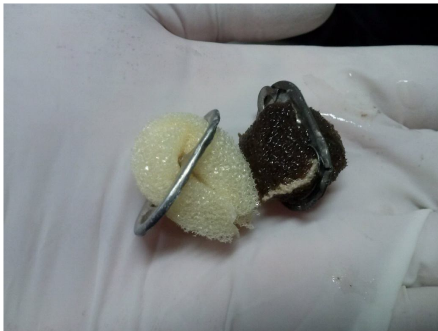
Figura 4.7: Meios suportes sem e com colonização da biomassa
