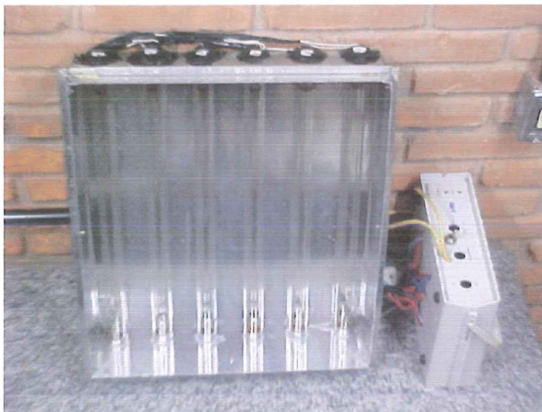
FIGURA 4.6 - Refletor removível de alumínio com as seis lâmpadas de baixa pressão de vapor de mercúrio.
