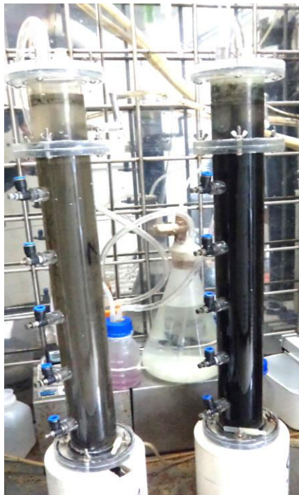
Figura 5.10. Imagens dos reatores metanogênico (esquerda) e sulfetogênico (direita). Note-se a diferença de cor entre ambos.
