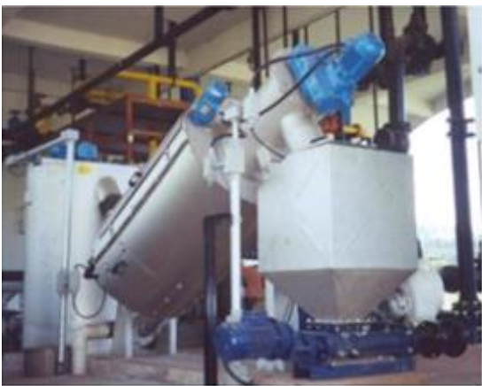
(c) Adensamento por Tambor Rotativo
