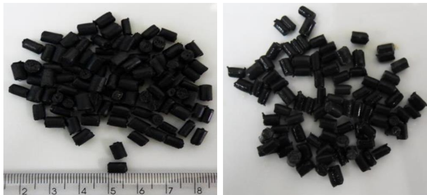
Figura 4.3 - Fotografia dos grânulos do material suporte sem (esquerda) e com (direita) biomassa
