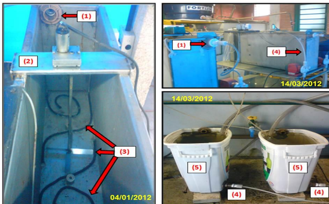
Figura 16 - Reatores de lodos ativados piloto: (1) tubulação de alimentação; (2) agitador do tanque de aeração; (3) difusores de ar; (4) tubulação de recirculação do lodo; (5) decantadores. Fotos da autora.
