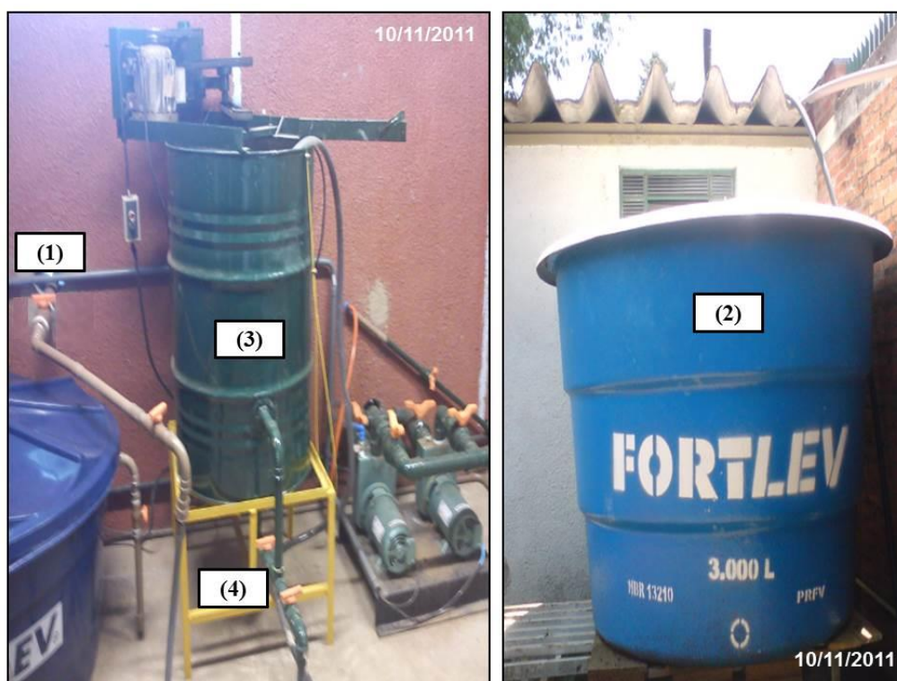
Figura 11 – Unidades experimentais para precipitação química do lixiviado: (1) tubulação para coleta do lixiviado bruto armazenado no (2) reservatório de 3 m 3 ; (3) reservatório com agitador mecânico; e (4) tubulação para coleta do sobrenadante e/ou remoção do lodo gerado. Fotos da autora.
