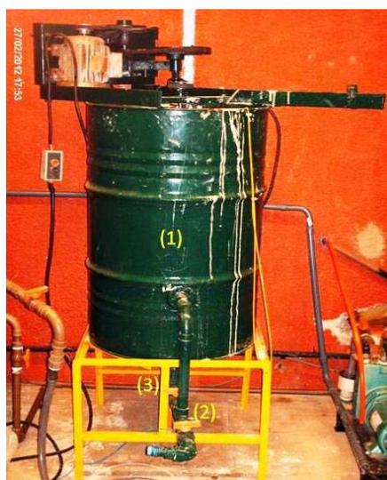
**Figura 5 – Agitador mecânico. (1) Tambor de 100 L; (2) Registro de saída do sobrenadante; (3) Registro de saída do lodo. Fonte: ALBUQUERQUE (2012).**
