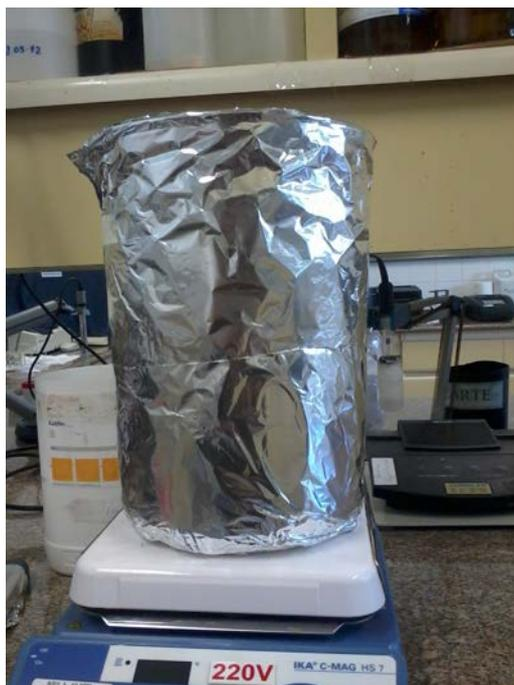
**Figura 7 - Unidade utilizada para batelada com Reagente de Fenton**
