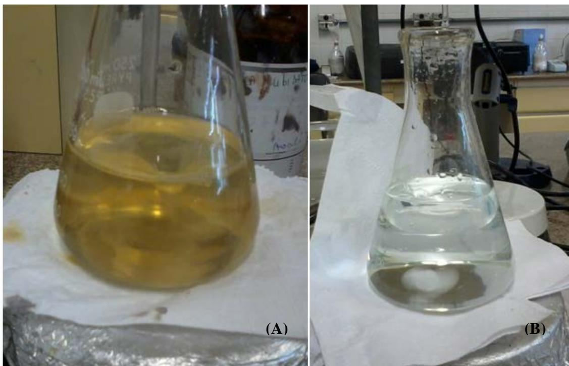
**Figura 8 - Ponto de viragem: (A) Solução com amostra de lixiviado efluente aos POAs Reagente de Fenton e foto-Fenton; (B) Branco e solução de  $H_2O_2$ .**
