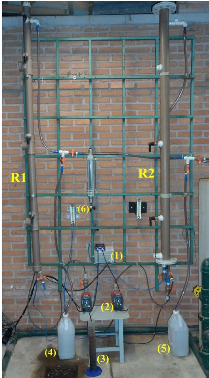
**Figura 9 – Biofiltros aerados submersos - R1 (controle) e R2 (Esgoto sanitário+lixiviado). (1) bomba peristáltica – recalque de lixiviado a 9,0 mL/h; (2) Bombas de recalque de esgoto sanitário – R1 330 mL/h, R2 450 mL/h; (3) Reservatório de lixiviado pré-tratado por Reagente de Fenton; (4) efluente de R1; (5) efluente de R2; (6) medidor de vazão de ar.**
