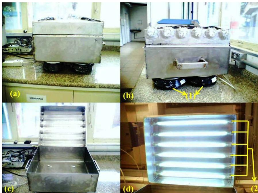
**Figura 6 – (a) visão frontal do reator UV; (b) visão lateral; (c) visão frontal do reator UV aberto; (d) visão do refletor com lâmpadas UV acesas; (1) agitadores magnéticos; (2) lâmpadas UV. Fonte: MONTEIRO (2012).**
