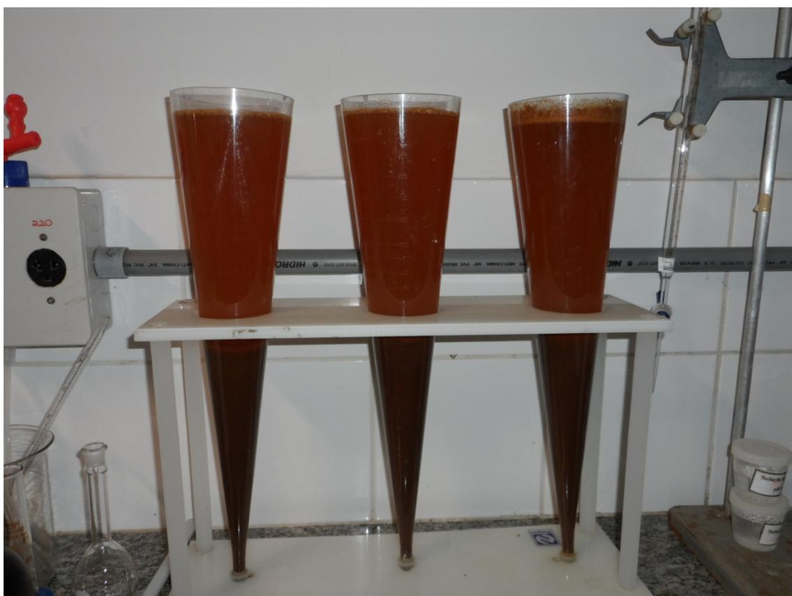
Figura 14 – Lixiviado pré-tratado por Reagente de Fenton, com pH ajustado a 7, após 4 horas de sedimentação.
