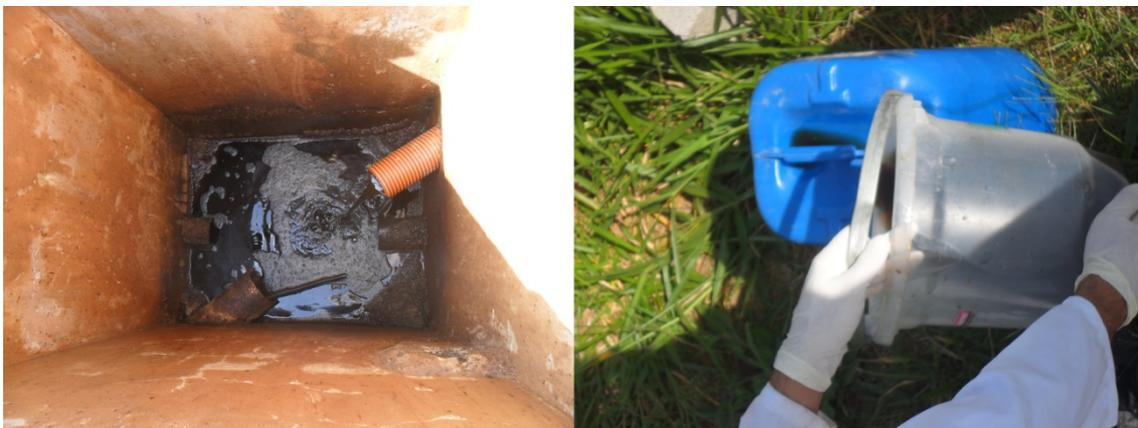
Figura 4 – Caixa de passagem onde o lixiviado foi coletado e armazenamento em bombona de plástico. Fonte: a autora.
