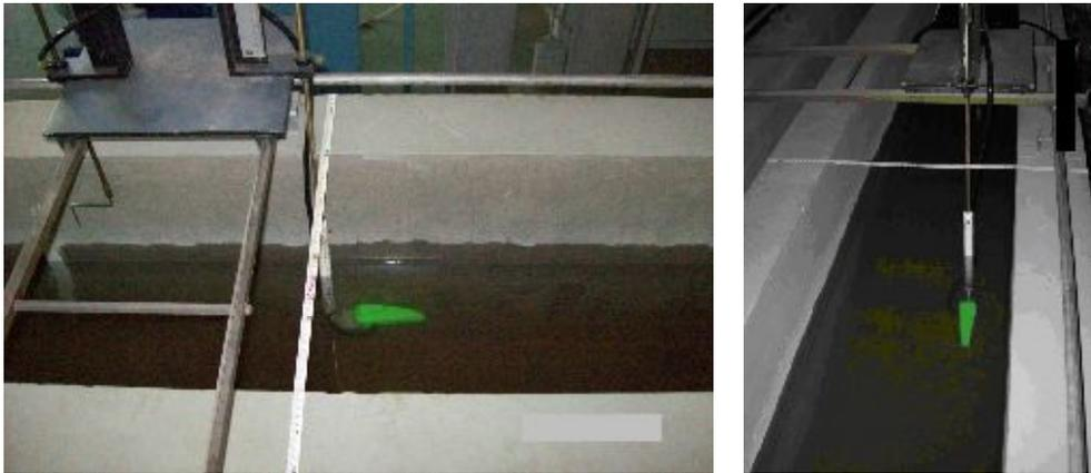
Figura 25. Detalhe do equipamento medindo a velocidade do escoamento no canal de 0,40m de largura
