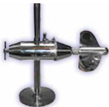
Figura 4. Molinete hidrométrico
