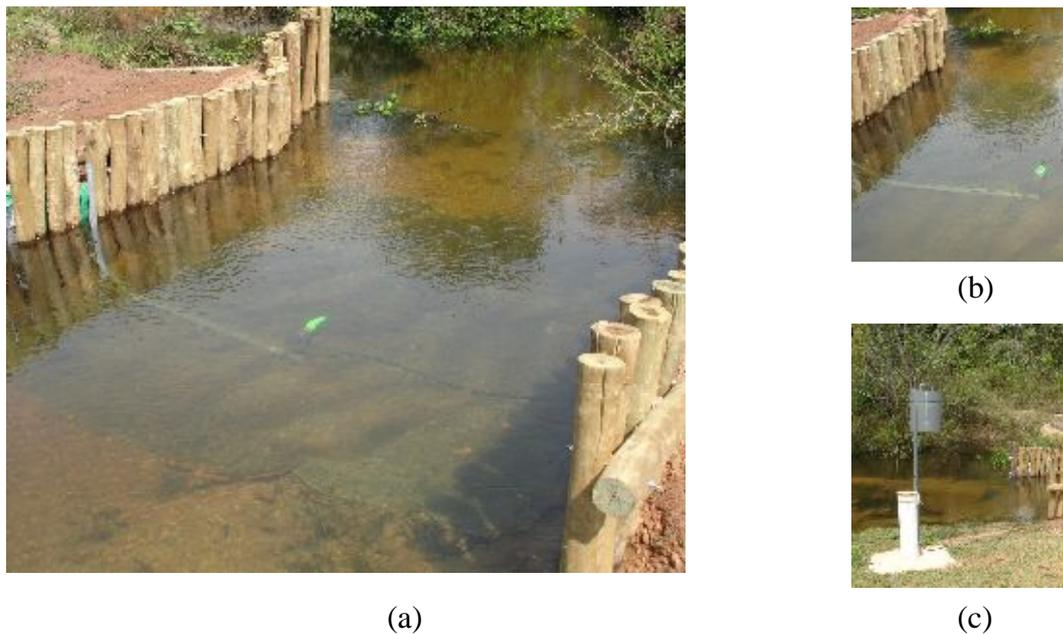
Figura 47. (a) Flo-Tote3 instalado na estação fluviométrica; (b) detalhe do sensor; (c) detalhe da caixa protetora do Flo-Logger
