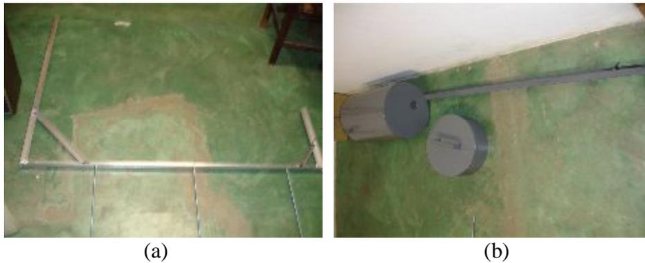
Figura 46. Suporte para o sensor (a) e para o Flo-Logger (b)
