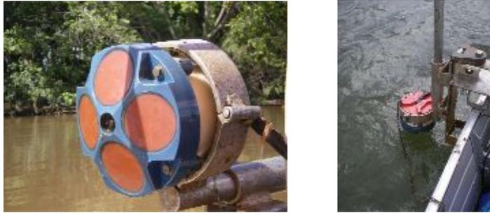
Figura 6. ADCP WorkHorse Rio Grande de 600 kHz, utilizado pela Itaipu Binacional
