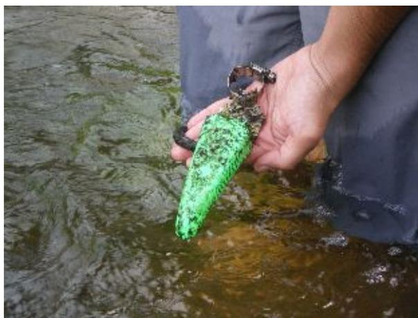
Figura 95. Detalhe dos sensores sujos do Flo-Tote que afetaram as medições de velocidade
