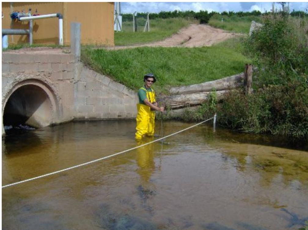
Figura 29. Seção de medição de vazão, situada a montante da ponte e a montante da casa de bombas. O hidrometrista está medindo velocidades com um molinete hidrométrico
