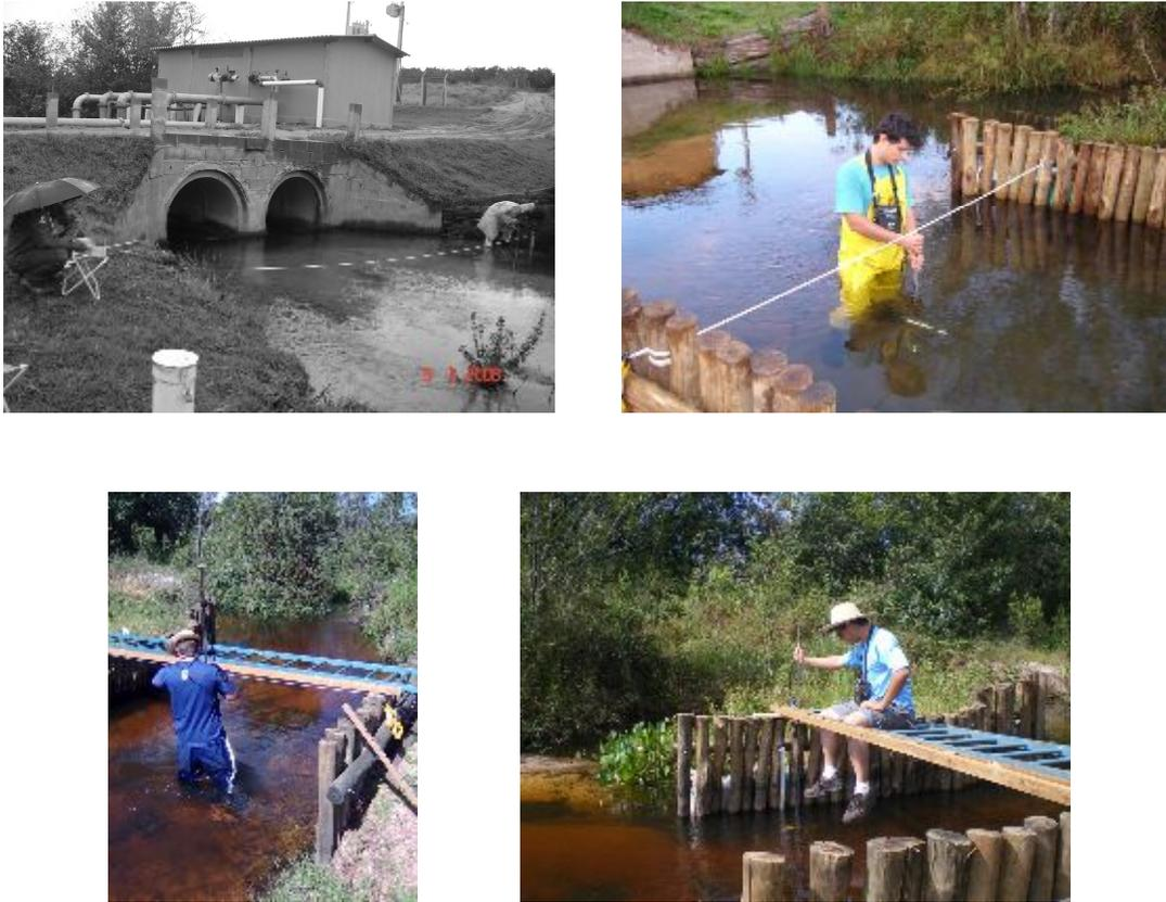
Figura 39. Estimativas de vazão na Bacia do Ribeirão da Onça, a montante da ponte
