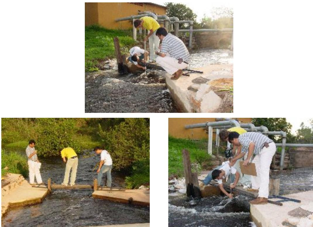
Figura 38. Estimativa de vazão com o auxílio do molinete na seção de estrangulamento, a jusante da ponte, na Fazenda Santa Maria da Fábrica
