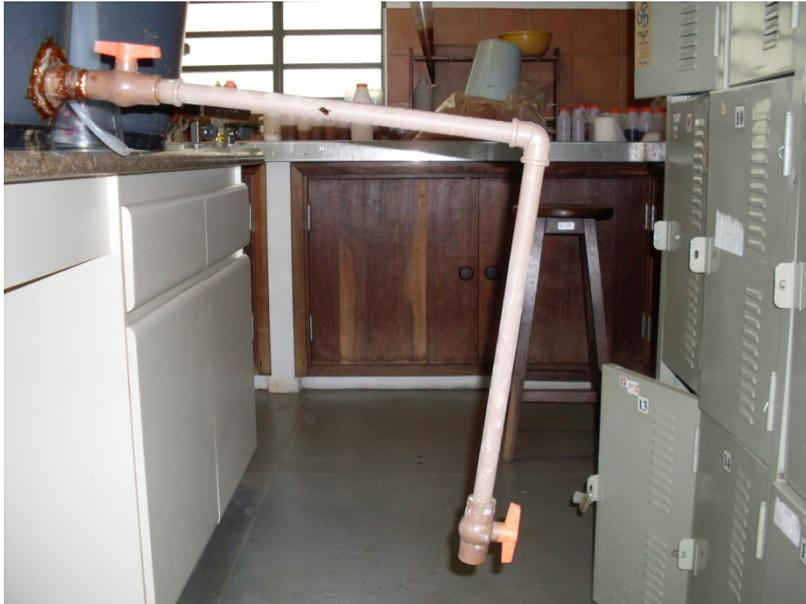
Figura 4.7: Coletor de lixiviado e a forma de coleta do lixiviado.
