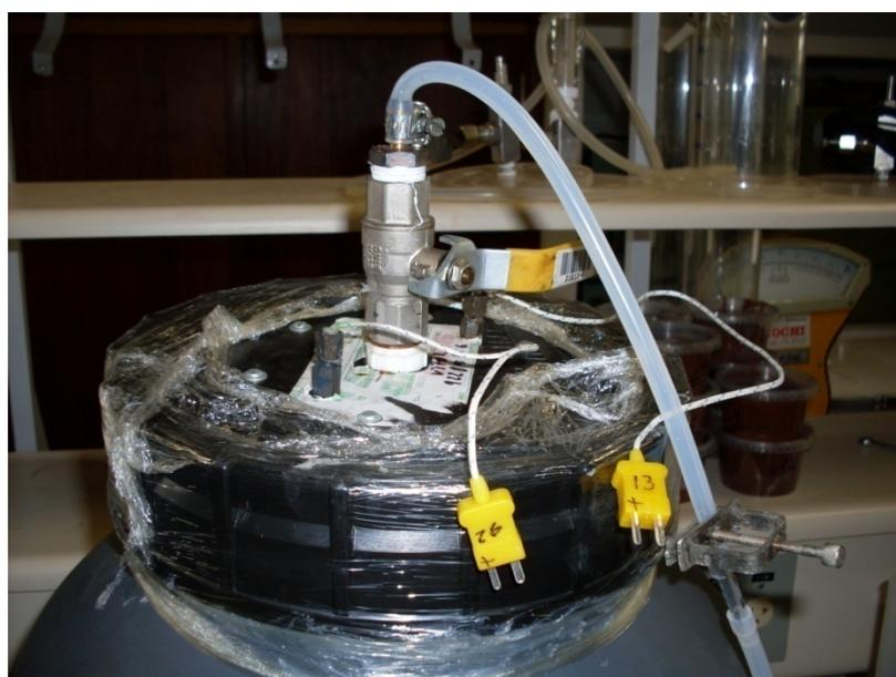
Figura 4.9: Adaptação feita na tampa do reator para coleta do biogás.
