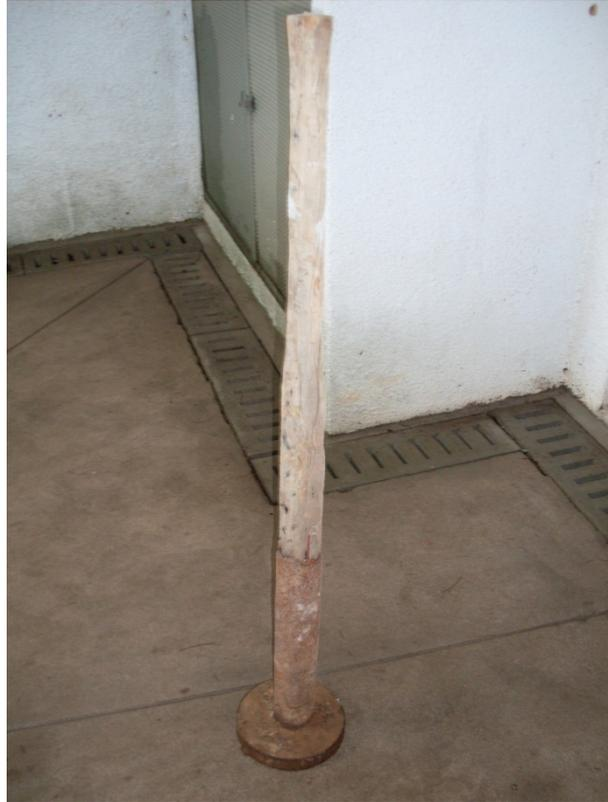
Figura 4.12: Ferramenta utilizada como compactador da FORSD.
