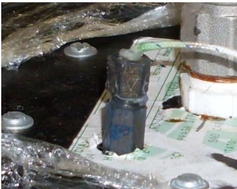
Figura 4.4: Adaptação das tampas dos reatores para medição da temperatura.
