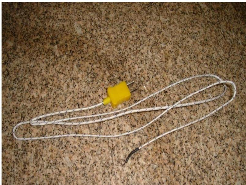
Figura 4.3: Termopar tipo K, utilizado para medição da temperatura no interior dos reatores.
