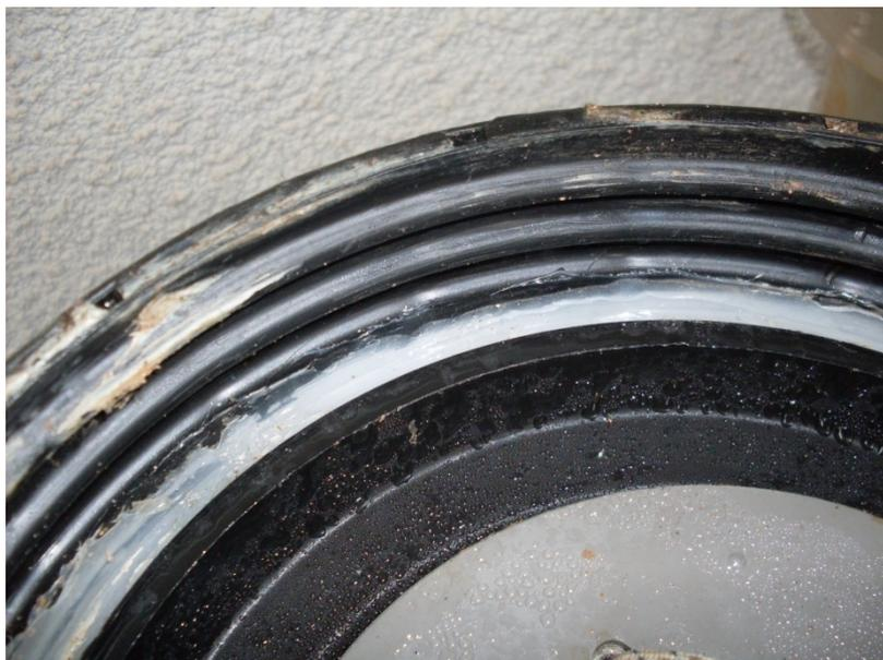
Figura 4.8: Adaptação feita na tampa do reator com aplicação de silicone.
