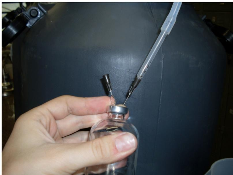
Figura 4.10: Coleta de amostra de biogás.
