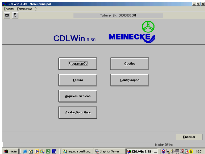
Figura 4.8 – tela do software CDLWin de programação e leitura dos coletores de dados
