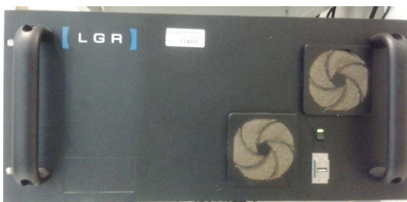
Figura 4.4 – Analisador de gases da LGR para medições de H_2S .
