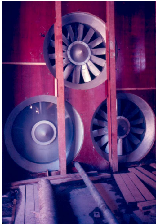
Figura 4.4: Montagem dos ventiladores - vista externa - Segundo Ensaio
