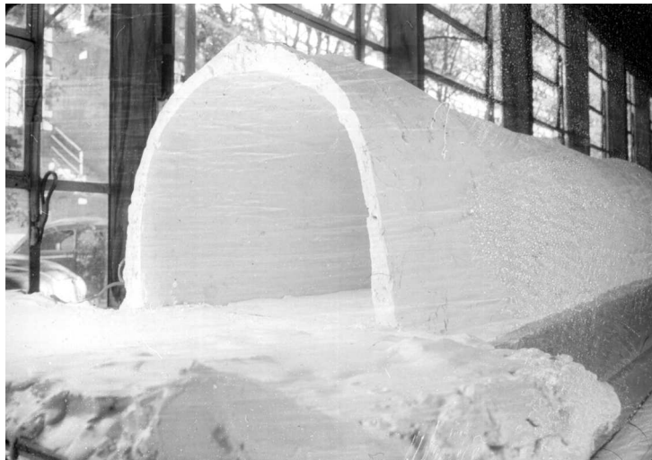
Figura 4.13: Modelo reduzido do Túnel 2 em gesso
