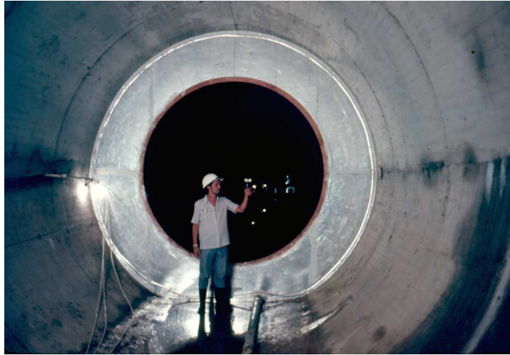
Figura 4.19: Medição da vazão no diafragma com Anemômetro Lambrecht - Segundo Ensaio
