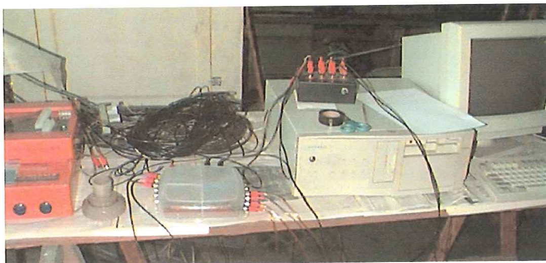
Foto 4 – Bancada: conversor CONAUT, circuito do sensor de passagem e microcomputador com placa de aquisição de dados.
