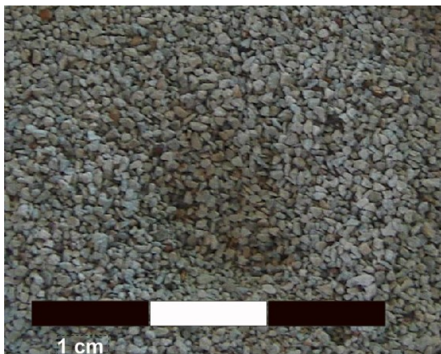
Figura 4.2 - Foto ilustrativa de amostra da zeólita utilizada na pesquisa.
