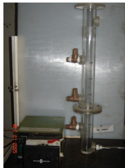
Figura 4.3 - Representação esquemática e foto ilustrativa da instalação da coluna de zeólita.
