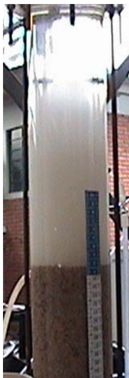
Figura 5.22- Desprendimento de flocos após execução da 5ª DFI na câmara 1 do FAAG
