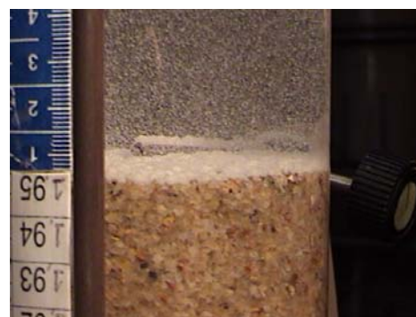
Figura 5.27 - Arraste de flocos e formação de manta no topo do meio filtrante do FAAG-C1 após 15 h do início do ensaio 6
