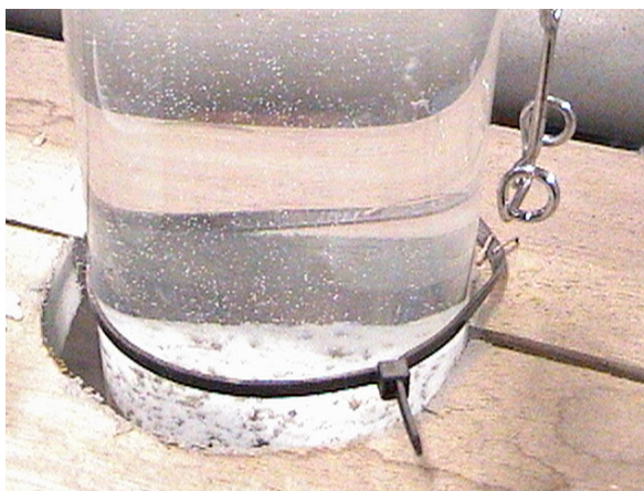
Figura 5.40 - Início do transpasse no FAP-C1 após 4 h do início do ensaio 12 de dupla filtração
