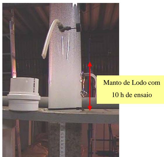
Figura 5.42 – Manto de lodo no FAP-C2 após 10 h do início do ensaio 14 de dupla filtração
