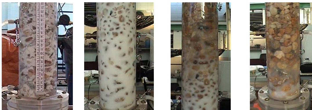
Figura 5.46- Descarga de fundo final no FAP-C1 após término do ensaio 14 de dupla filtração
