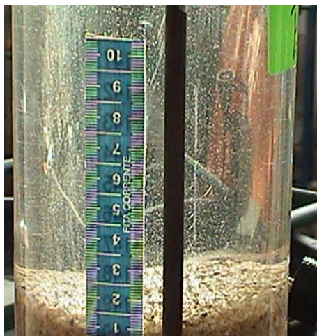
Figura 5.24 - Início do transpasse no FAAG-C1 após 19,5 h do início do ensaio 4
