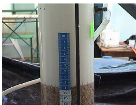
Figura 5.31 - Detalhe do manto de lodo no FAAG-C1 após 27 h do início do ensaio 8
