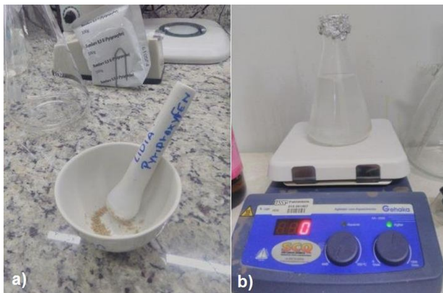
Figura 7 - Preparação da solução estoque de Pyriproxyfen (5mg/L). a) trituração manual do Sumilarv 0,5G®; b) agitação da solução estoque de Pyriproxyfen em agitador magnético.
