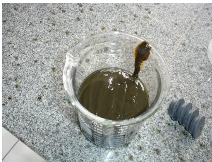
Figura 4.3 – Aspecto do lodo de inóculo após fragmentação dos grânulos.
