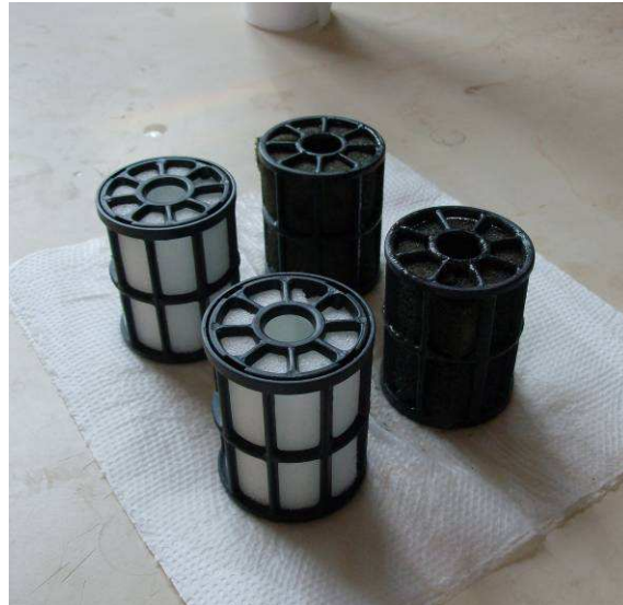
Figura 5.26 – Material suporte de RA limpo (esquerda) e colonizado após período de adaptação de RA (direita), na terceira etapa da pesquisa.
