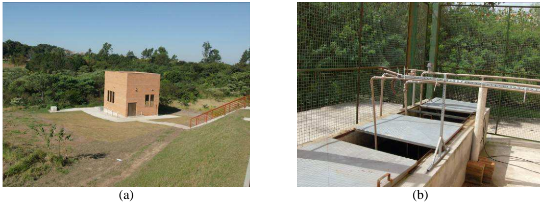
Figura 4.20 – Área de Pesquisa em Tratamento de Esgoto Sanitário do Laboratório de Processos Biológicos (LPB), para experimentos com esgoto sanitário real: (a) vista do edifício; (b) reservatório de esgoto sanitário para alimentação dos reatores.
