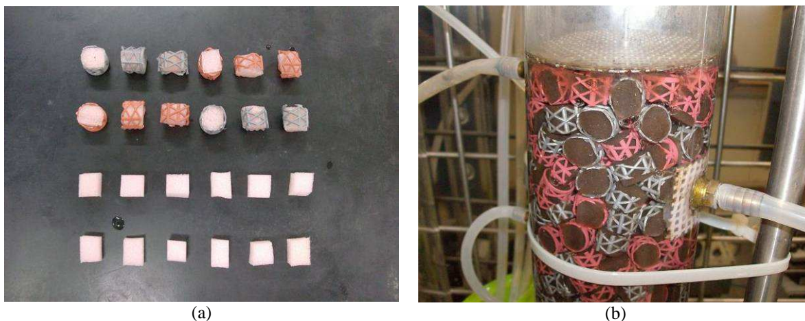
Figura 4.7 – Material suporte utilizado no reator R2, na segunda etapa da pesquisa: (a) detalhe; (b) no reator em operação.
