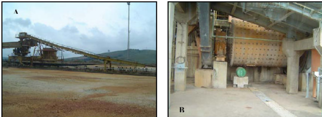
Figura 3.2. Visão geral das unidades desativadas do processamento de minério na mina Osamu Utsumi. (A) Mineroduto que conduzia o minério da extração até as unidades físicas de redução de tamanho do minério. (B) Tambor onde ocorria a operação de moagem do minério.
