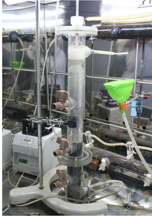
Figura 4.5. Foto do reator UASB instalado em câmara de controle de temperatura.
