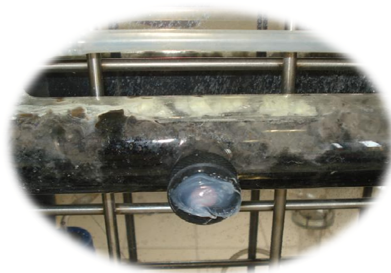
Figura 5.45. Acúmulo de S^0 no leito do reator R1.
