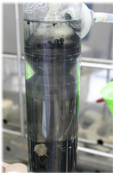
Figura 5.57. Formação de película amarelada no interior do reator UASB, durante a segunda fase de operação.
