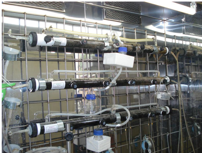
Figura 4.3. Foto dos reatores anaeróbios horizontais de leito fixo (RAHLF) em operação, instalados na câmara para controle de temperatura.
