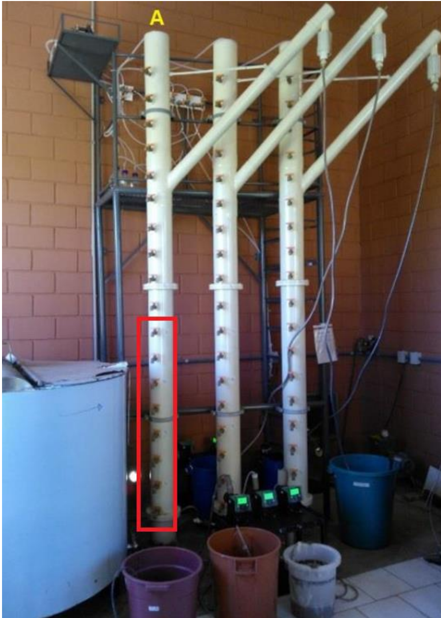
Figura 74 – Fotografia do reator UASB (R2) piloto operado por Del Nery et al. (2016). Obs. Pontos de amostragem na manta de lodo indicado em vermelho
