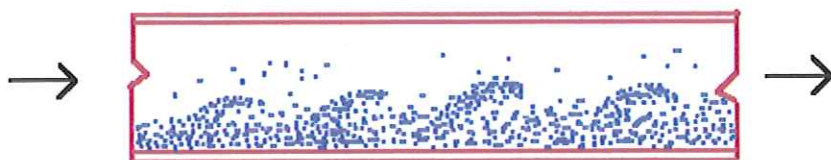
Figura 1: Escoamento Saltitante com camada estacionária no fundo.
