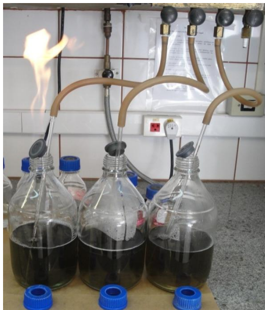
Figura 4.2: Reatores anaeróbios em batelada utilizados nos ensaios de produção de hidrogênio
