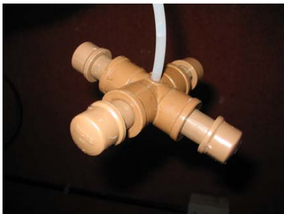
Figura 27 – Distribuidor de vazão (vista superior)
