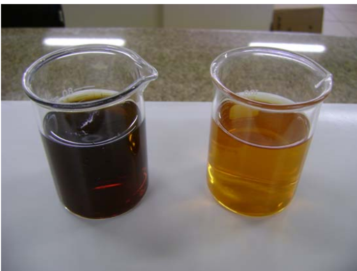
Figura 75 – Lixiviado bruto (à esquerda) e o sobrenadante da alcalinização com hidróxido de cálcio. Note-se a grande remoção de cor.
