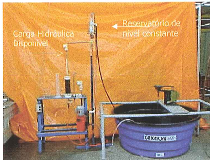
Figura 4.2 - Instalação de Filtração com CAGIP
