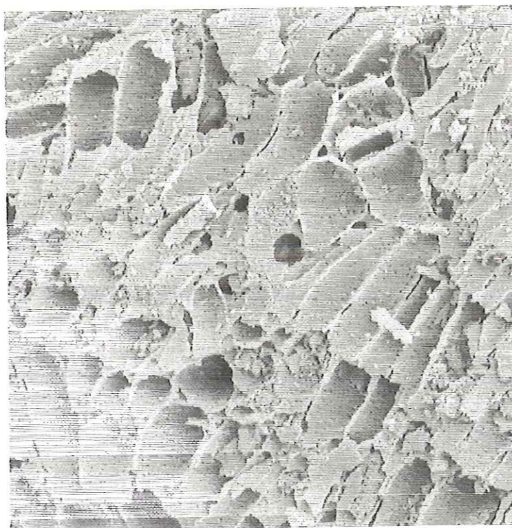
Figura 5.26 – Sítios de ativação do CAGIP, sem contato com água Aumento de 500x
