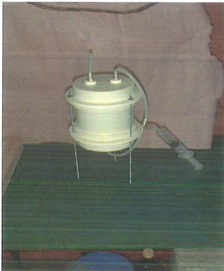
Figura 4: Biorreator adaptado para a recirculação do percolado
