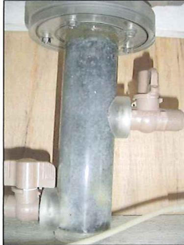
Figura 5.23 - Lodo da base do Reator 3
