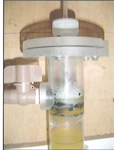
Figura 5.24 - Lodo flotado no Reator 3
