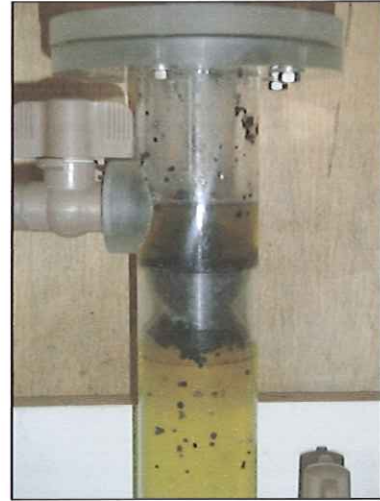
Figura 5.20 - Lodo flotado no Reator 1
