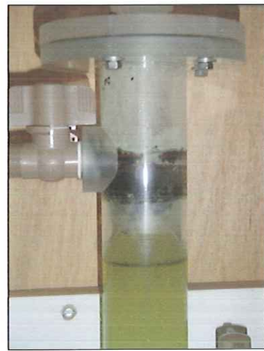
Figura 5.22 - Lodo flotado no Reator 2
