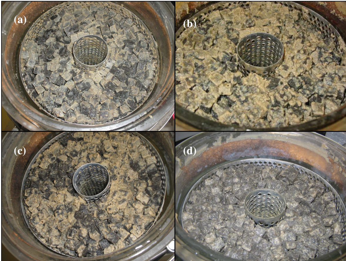
Figura 31 - Evolução dos polímeros formados quando o reator foi alimentado com 296 (a), 530 (b), 735 (c) e 1104 mg/L de formaldeído(d)
