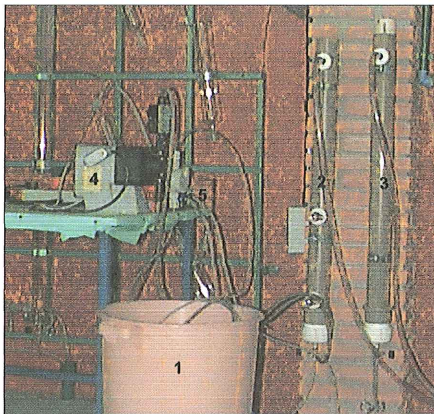
Fotografia 18 – Unidade experimental utilizada para avaliar a eficiência dos meios suporte carvão ativado granular e espuma de poliuretano. (1- recipiente para armazenar o efluente ozonizado, 2- coluna com carvão ativado granular, 3- coluna com espuma de poliuretano, 4- bombas dosadoras, 5- aeradores)
