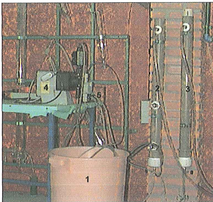
Fotografia 6 – Unidade experimental para escolha do meio suporte (1- recipiente para armazenar o efluente ozonizado, 2- coluna com carvão ativado granular, 3- coluna com espuma de poliuretano, 4- bombas dosadoras, 5- aeradores)
