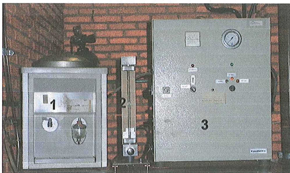
Fotografia 3 – Geladeira (1), rotâmetro (2) e gerador de ozônio (3).
