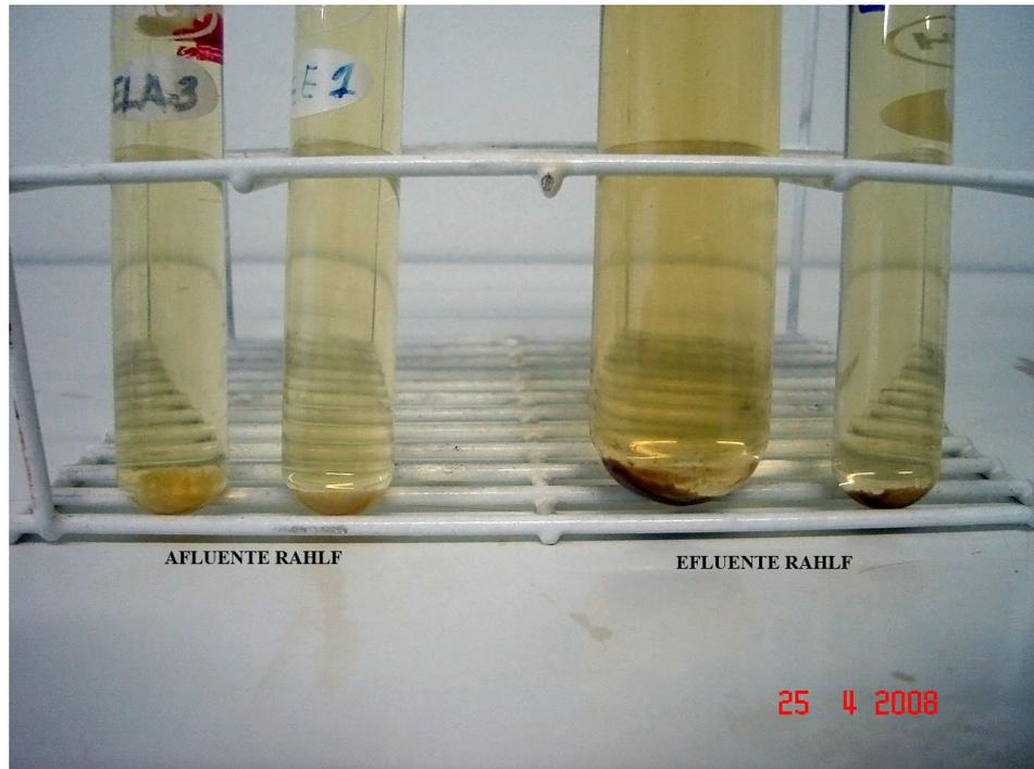
**Figura 5.15.** Comparação do ácido húmico precipitado em ácido no afluente e efluente do RAHLF-II.
