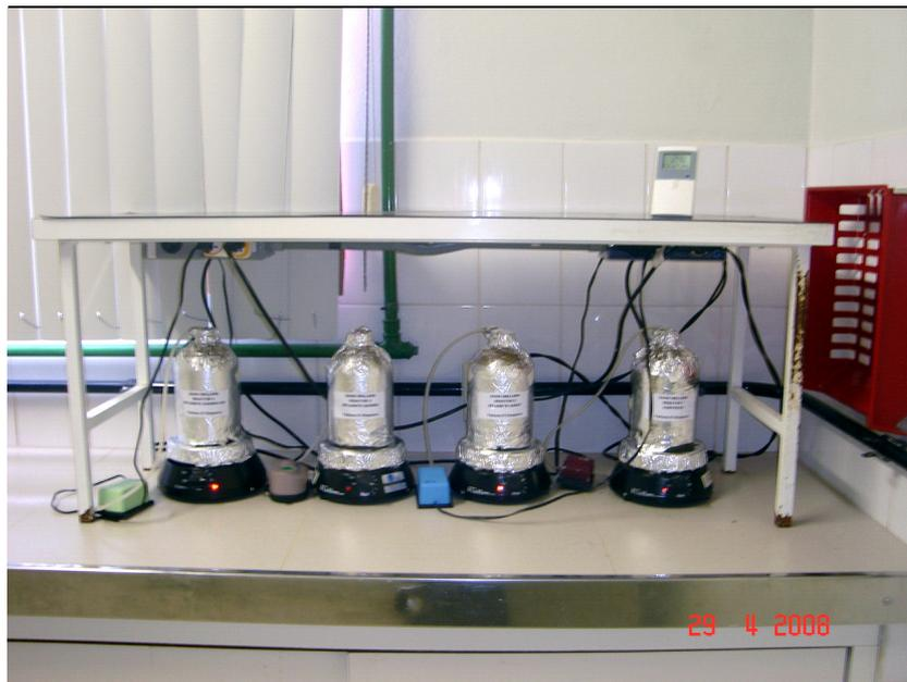
**Figura D2.** Vista geral da montagem do teste de Zahn- Wellens
