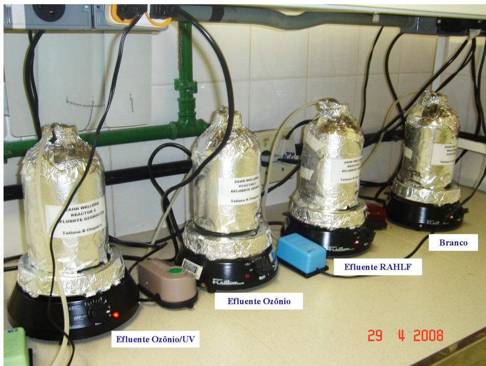
**Figura 4.12.** Montagem do teste de biodegradabilidade aeróbia – Zahn-Wellens.
