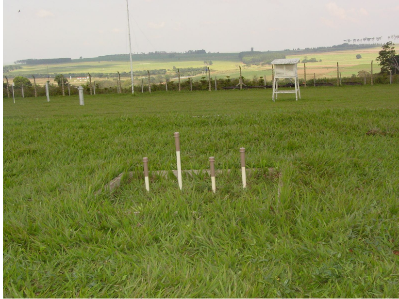
Figura 6 – Lisímetro com os quatro tensiômetros instalados.
