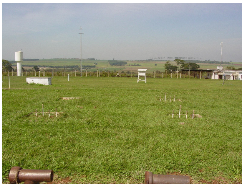
Figura 5 – Tensiômetros instalados nos lisímetros de drenagem livre por gravidade.
