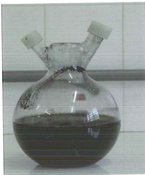
Figura 1. Reator em batelada usado nos ensaios de degradação de tolueno.
