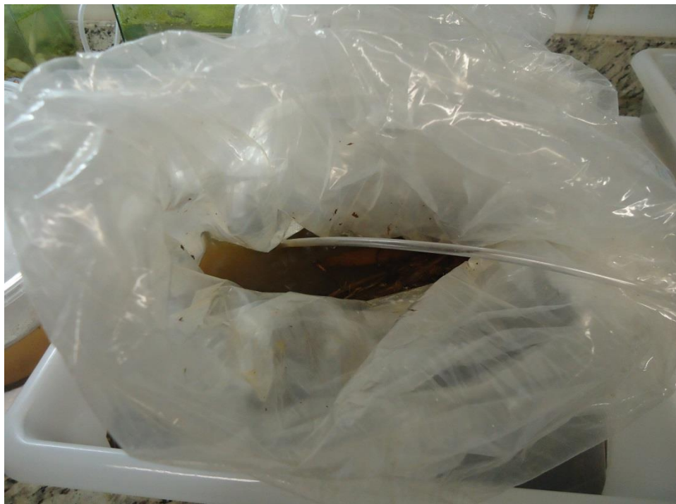
Figura 9 - Acondicionamento dos macroinvertebrados aquáticos em sacos plásticos com oxigenação. Fonte: própria autora.
