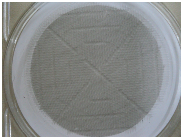
Figura 27. Acúmulo de material particulado em membrana de 47mm de Teflon® após coleta de 4 horas.
