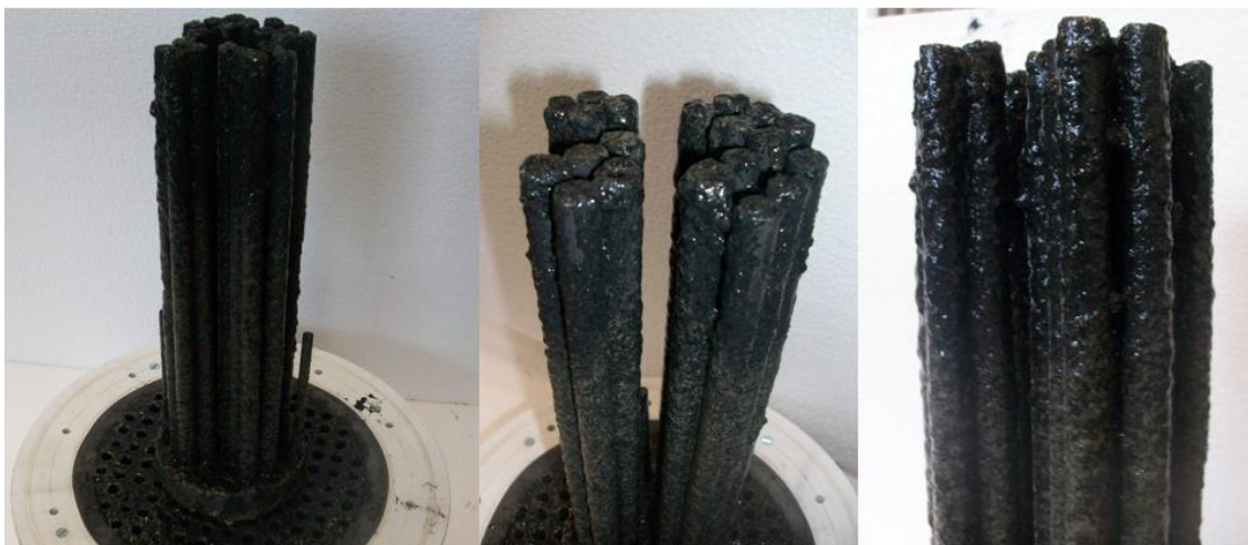
Figura 5.1 - Biomassa aderida aos eletrodos do anodo ao final da operação da CCM.
