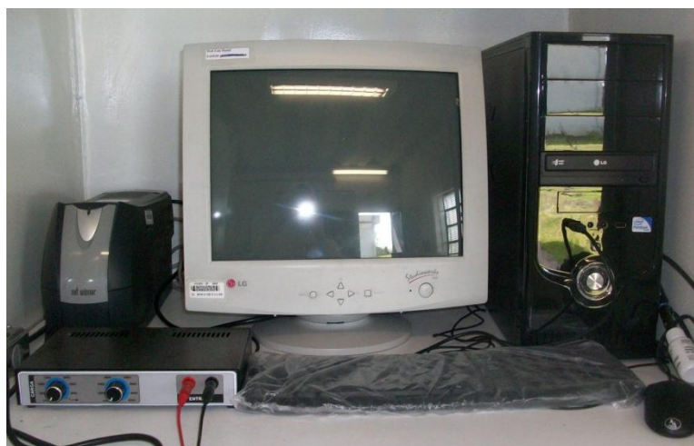
Figura 4.5 - Fotografia do sistema de aquisição de dados e do computador para armazenar as leituras de tensão em corrente.
