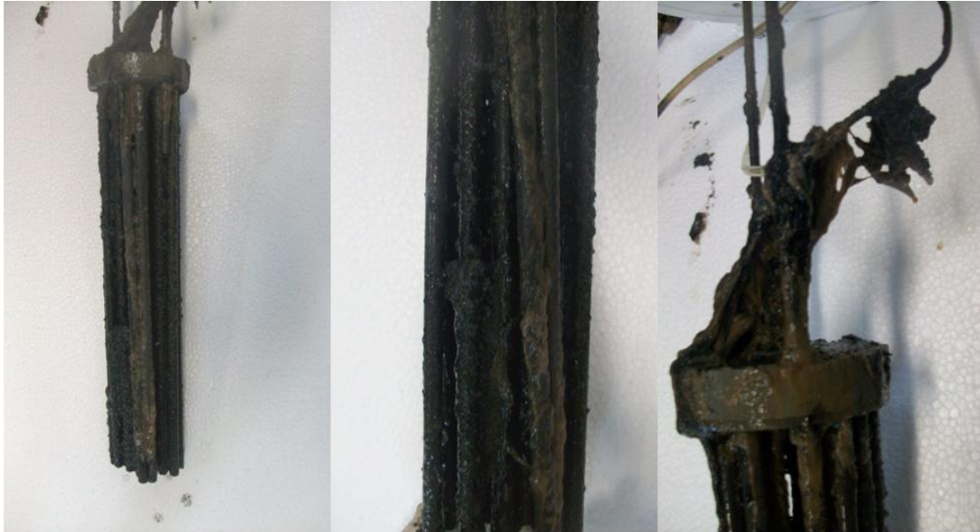
Figura 5.2 - Biomassa aderida aos eletrodos do catodo ao final da operação da CCM.
