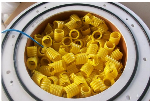
Figura 4.2 - Detalhe da câmara intermediária com ênfase no preenchimento com conduítes de plástico.
