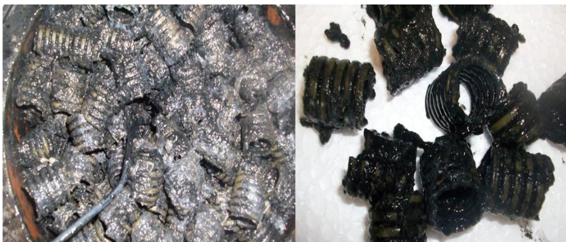
Figura 5.3 - Biomassa aderida nos anéis de conduíte da câmara intermediária.
