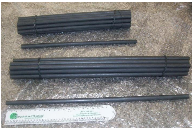
Figura 4.7 - Barras de grafite utilizadas como eletrodos na CCM.
