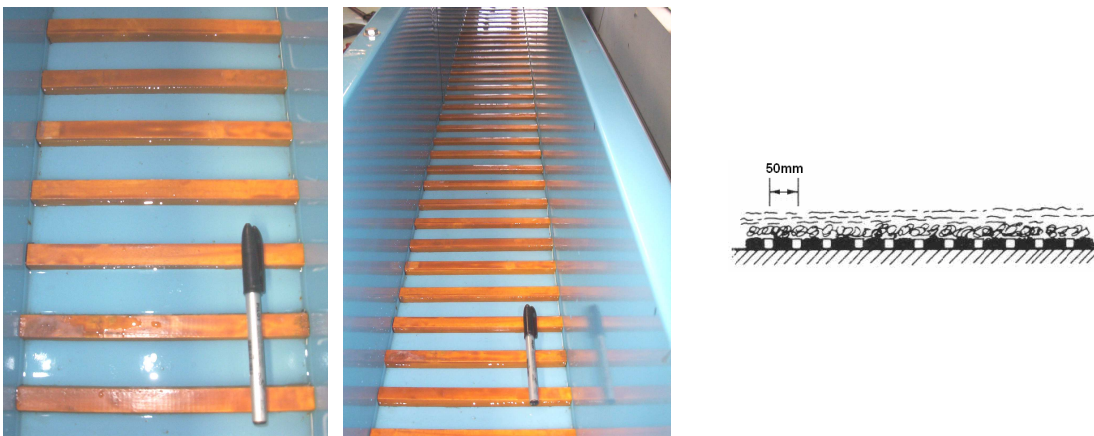
Figura 33 – Configuração geométrica do leito para o escoamento quase liso ( \lambda/K = 3,3 ).
